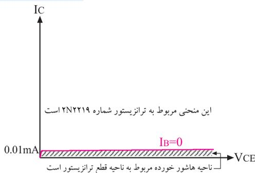
شکل ۱-۱۲ ناحیه قطع در منحنی مشخصه ی خروجی ترانزیستور
