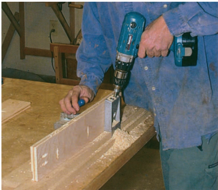
شکل ۲-۸۳- عملیات سوراخ کاری اتصال مورب با پیچ به وسیله شابلون مربوط
