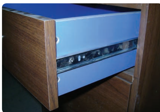
شکل ۶-۵۶ ریل مکانیکی نصب شده در بدنه جعبه
