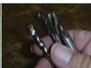
چنانچه جنس متہ اصلی نباشد و یا فشار وارد با آن متناسب نبوده و قطعه کار نیز دارای رگه‌های متفاوتی باشد، متہ خواهد شکست. در تصویر متہ نامرغوبی را ملاحظه می‌کنید که در فشار کاری باز شده است!
