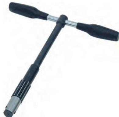
باز به خاطر آنکه عملیات بُراشه برداری برقو بسیار سبک است، می‌توان با یک ابزار دستی ساده نیز آن را به داخل سوراخ هدایت کرد و الزاماً نیاز به دستگاه خاصی ندارد. در تصویر طرح‌هایی را برای ابزار دستی برقوکاری مشاهده می‌کنید.
