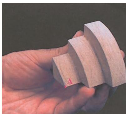
برش ذوزنقه‌ای که در کف این یاتاقان مشاهده می‌شود، اندازه داخلی و سوراخی است که بسته نیست و آن را به‌خاطر ظاهرش سوراخ دمچلجه می‌نامند. از
