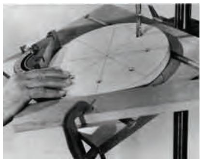
تصویر سوراخکاری یک دیسک چوبی را مشاهده می‌کنید که در آن از میزی با یک سوراخ پاکت طولانی امکان سوراخکاری سریع و پیوسته روی محیط دیسک بدون نیاز به «قید و بست»<sup>۱</sup> را فراهم کرده است. در تصویر بعدی ایجاد طرحی برای سوراخکاری دقیق و زاویه‌دار قطعات چوبی را ملاحظه می‌کنید.
