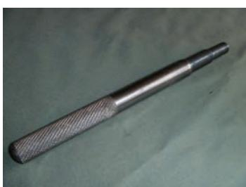
در دسته قلاویز نمونه انتخاب شده که فقط یک فک متحرک دارد، دسته متحرک، شامل دو پله رزوه کاری شده است که اولی برای جای گرفتن در کلگی دسته و دومی برای پیش رانش لقمه قفل کننده به کار خواهند رفت.
