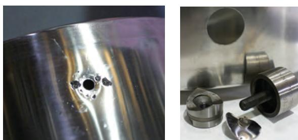
از پیچ‌های دندانه‌مثلثی استوانه‌یا نوک‌دار برای اتصال قطعات به صورت موقت (بازشدنی) استفاده می‌شود. البته خلاقیت در گرفتن ایده از این سیستم به صنعتگران کمک کرده است تا از آن برای ساخت ابزارهای سوراخ‌کن ورق بهره ببرند.
