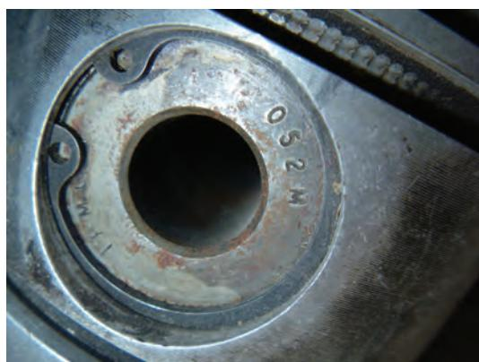
پس از ساخت یک قطعه سوراخ دار به کمک مته‌ها و سپس افزایش کیفیت سطح سوراخ و درصد نزدیکی آن به دایره واقعی با ابزار برقو، می‌توان یک پین دقیق‌شده را در آن جا زده اتصالی را کامل و یا محور دورانی را فراهم کرد. اما در حین کار پین‌ها به تدریج تمایل به خارج شدن از سوراخ قطعه پیدا می‌کنند. به همین خاطر باید با کمک ابزارک‌هایی مانند حلقه‌ها و خارها و پولکی‌ها، مسیر حرکت پین‌ها به بیرون را مسدود کنیم.
