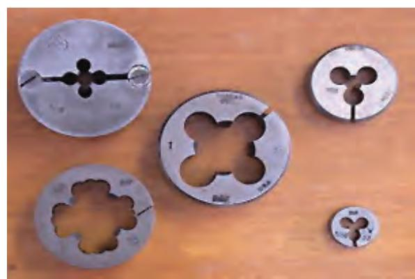
گاهی از «حدیده» بدون دسته‌حدیده نیز می‌توان استفاده کرد. این نوع حدیده‌ها که از محیط شش‌ضلعی برخوردارند، با کمک انواع آچارهای سازگار قابل راهبری بوده و بیشتر برای اصلاح رزووه‌های ساییده استفاده می‌شوند. این حدیده‌ها به «حدیده مهره‌ای»<sup>1</sup> موسوم هستند.
