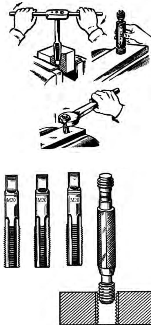
بر روی یک پیستون آلومینیمی مستعمل از خودروهای سنگین سوراخ ۸mm ایجاد کرده و آن را به سوراخ M10 تبدیل کنید. سپس قطعه را برش زده، رزووه‌ها را ارائه دهید. هنگام تعیین ارزش قلاویزکاری یک سوراخ، باید ارزش
