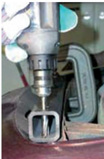
\* با تهیه دو یا سه مکعب آلومینیمی  $50\times 50\text{ mm}$ ، سوراخ‌هایی به قطر  $8-10\text{ mm}$  را با استفاده از مته‌های کهنه و نو و یا بدون استفاده از مایع خنک‌کننده در سرعت کم و زیاد، در آنها ایجاد کرده و سپس قطعات را برش متقارن بزنید. آنگاه با تهیه گزارش و جداول کامل از شرایط کار، به همراه تصاویر نتیجه فعالیت‌ها، آن را به عنوان پروژه (۳۷) شماره «۳۷» کارگاه فلزکاری ارائه دهید.
