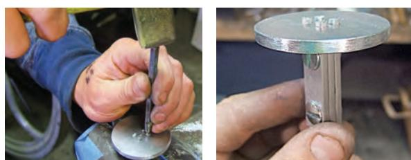
یک نمونه از «فرایند تکمیل» یا توسعه صنعتی را در تصویر زیر و در جازئی دسته این قلاویز گیر (قلاویز گردان) مشاهده می کنید. در این ایده جدید ساقمه فنری که در
