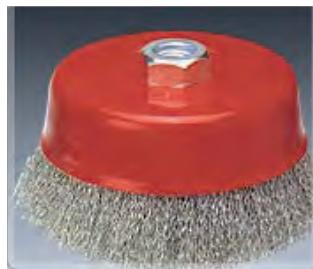
میزان فشردگی و تراکم رشته‌ها، طول رشته، قدرت انعطاف رشته که از جنس الیاف سرچشممه می‌گیرد و بالاخره قدرت پشتیبان رشته‌های فرچه تعیین‌کننده میزان تأثیر و براده‌چینی ظرفیت آن از سطوح قطعات کار است.
