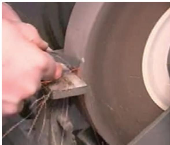
مناسب و نسبتاً زیاد دست در کنار رعایت احتیاط و با مهارت، قبل از آنکه فولاد تُندبُر بر روی سنگ و ذرات آن اثر سایشی بگذارد، آن را در تهاجم ذرات ساینده تیز کرد. در این صورت حتماً حفاظ تلقی سنگ را نصب کرده و از تماس مستقیم (ضریب‌گون) ابزار با سنگ پرهیز کنید. روش صحیح (مطابق تصویر)، مماس کردن ابزار برشی به سنگ و افزایش تدریجی فشار بر سنگ تا لحظه براده‌برداری مطلوب است.
