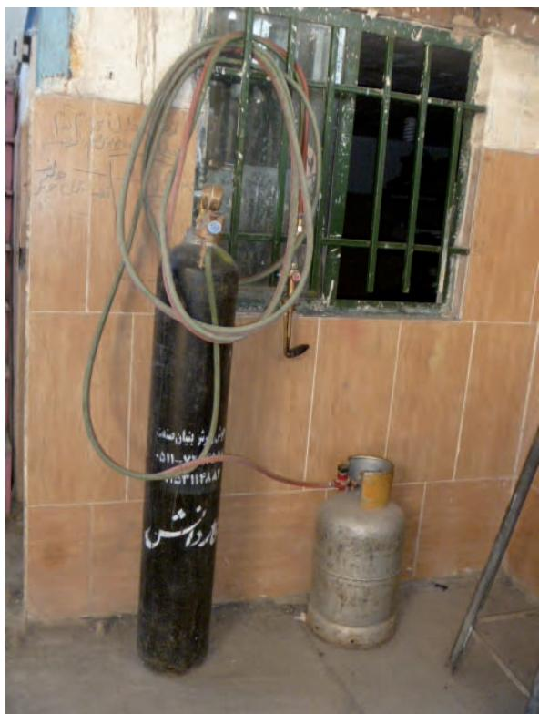
در کارگاه فلزکاری و سایت‌هایی که عملیات فلزکاری در آنها انجام می‌شود، دو کپسول اکسیژن (سوزاننده) و اکسیاستیلن و گاز کاربید (سوختنی) به‌طور معمول استفاده‌های زیادی برای اتصال (جوشکاری) و یا برش کاری دارند که در کنار کپسول‌های گاز آرگون و CO<sub>2</sub> برای جوشکاری‌هایی به همین نام، نیاز شما برای شناخت روش کار با کپسول‌های گاز تحت فشار، رنگ و
