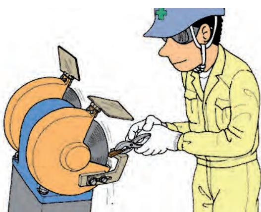
سنگ‌های فرز (تیغه‌های نازک ماسه‌ای) خطرناک‌ترین ابزار خانواده سنگ‌ها و در نتیجه حادثه‌سازترین ابزار کارگاه‌های فلز کاری‌اند. حتی شدت پرتاب براده‌ها و
