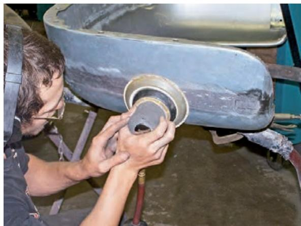
از سوی دیگر به هنگام پرداخت سطوح با استفاده از سنگ سنباده یا کاغذ آن و نیز فرچه‌های سیمی و لیفی، غبار و بُراده‌های بسیار ریز و بسیار خطرناکی از سطح قطعه کار جدا می‌شود که مجاری تنفسی و پوست شمارا
