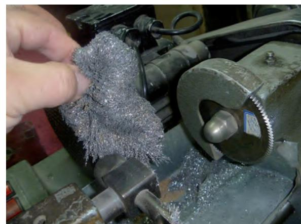
قاییده‌شدن ابزار یا دست به هنگام سنگزنی از شایع‌ترین حوادث گزارش شده در کار با سنگ دیواری است. بنابراین ضمن پوشیدن لباس‌های کاملاً جذب و بسته از به همراه داشتن ساعت، انگشت‌تری یا زیورآلات آویزان به هنگام کار با سنگ‌ها جداً پرهیز کنید
