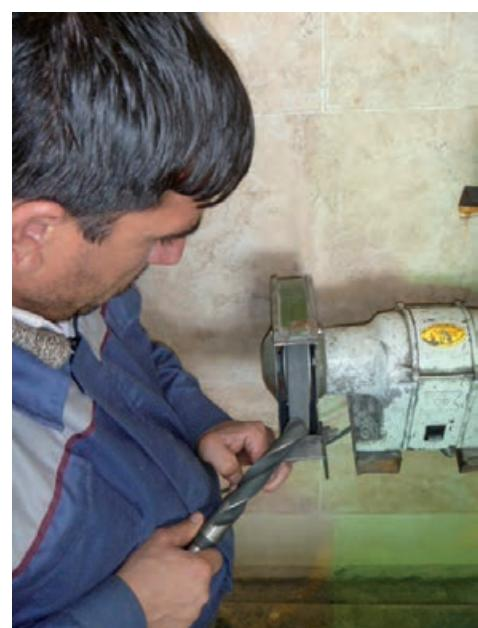
چنانکه قبل نیز اشاره شد، در اثر عدم وجود تجربه کافی در تیز کردن مته، عیوبی در نوک تیز شده آن و در نتیجه در فرایند سوراخ کاری با متنه معیوب بروز می کند که اطلاع از جزئیات آنها شما را در تشخیص صحیح یا غیر صحیح بودن عملیات ابزار تیز کنی، همراهی می کند. نمونه این جزئیات را می توان در جدول زیر ملاحظه کرد.
