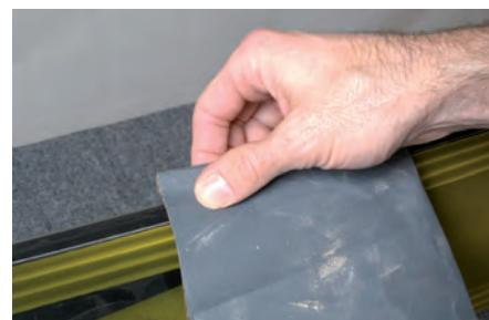
چنانکه در تصاویر مشاهده می‌کنید از «کاغذ سنباده»<sup>۴</sup> با انعطافی که دارد می‌توان در اشکال مختلف و برای سایه‌زنی در سطوح قطعات کار یا هموار کردن شیب‌ها و قوس‌ها استفاده کرد.
