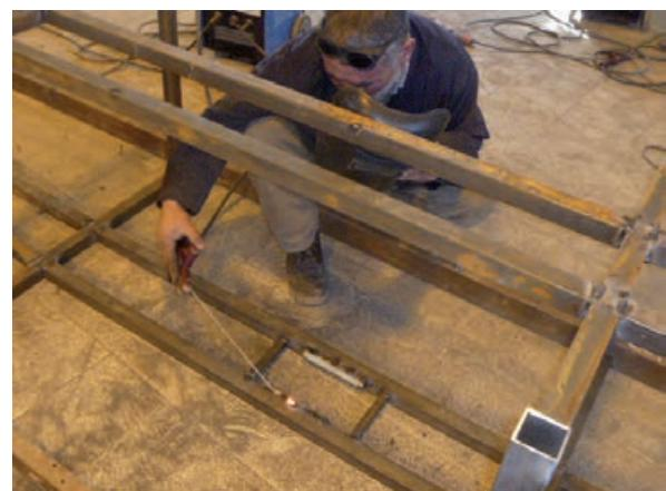
انتخاب آمپر مناسب (شدت جریان الکتریکی مورد نیاز جوشکاری) بر اساس ضخامت قطعات کار و با استفاده از تجهیزات مختلف مانند ترانس جوش پله‌ای (با انتخاب محدود)، ترانس جوش فلکه‌ای (با انتخاب آمپر نامحدود) و ترانس‌های جوش پیشرفته، به مهارت جوشکار و زاویه مناسب کاری وابسته است. اما انتخاب الکترود یا روش درست جوشکاری باید با توجه به استانداردهای صنعت جوشکاری انجام شود.
