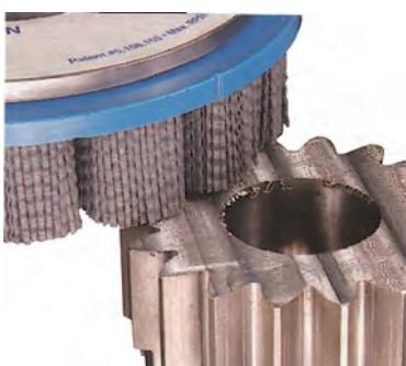
ضعف اصلی فرایند پرداخت با فرچه‌های برقی و دستی، عدم کنترل دقیق بر روی حرکت رشته‌ها و نیز عدم کارایی ابزار فرچه در قسمت‌های دور از دسترس قطعات
