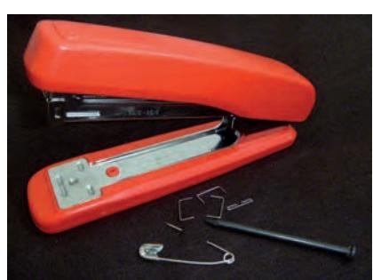
روش‌های «اتصال موقت» روش‌هایی از اتصال هستند که قصد برقراری ارتباط دائم بین اجزاء را در این روش‌ها دنبال نکرده‌باشیم. و راه برای تجدید نظر یا تعویض ساده و بی تخریب اجزاء فراهم باشد. از آنجا که «تخرب نشدن» به هنگام باز شدن اتصال شرط اساسی دسته‌بندی آنها به اتصال موقت، نیمه موقت و دائم است بنابراین، انجام غیر اصولی و عجولانه روش اتصال موقت با استفاده از یک
