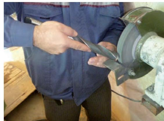
اگر در این هنگام یکی از لبه‌های برنده متنه کاملاً با سنگ مماس باشد، با مقداری فشار و چرخش همزمان و هموار بر سطح برش متنه، یک مسیر برشی جدید و تازه با قوس ملایم و نه چندان محسوس در پشت لبه برنده مذکور ایجاد می‌شود. با تکرار این عمل بر روی سطح لبه برنده دیگر و مقایسه مرتب این دو، ضمن حفظ زاویه رأس متنه و حفظ مرکزیت رأس آن، سطوح برشی جدیدی به وجود می‌آید و متنه تیز می‌شود.
