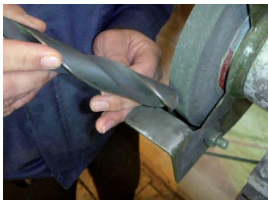
دستور کار چنین است که با قرار دادن انگشت اشاره دست چپ یا بخشی از آن در شیار مته، با دست دیگر
