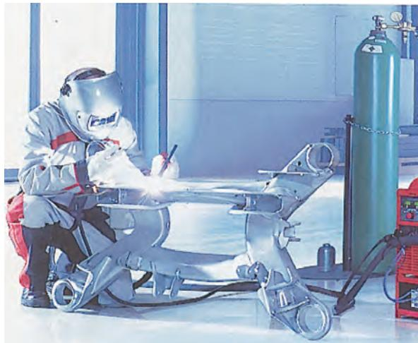
روش‌هایی مانند جوشکاری «تیگ<sup>۱</sup>» و «میگ<sup>۲</sup>» و «مگ<sup>۳</sup>» می‌توانند جوش‌هایی با حدود دو برابر استحکام نسبت به جوش برق معمولی با الکترودهای روکش‌دار در فلزات آهنی را به وجود بیاورند ولی به همان نسبت به حساسیت و حرارت و اشعه‌های مضر بیشتری نیز برخوردارند.
