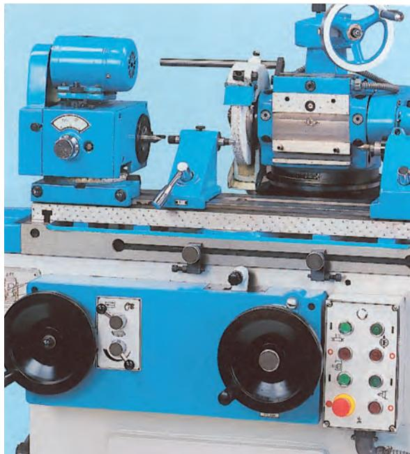
در سنگزنی بیش از سایر فرایندها، از مایع خنک‌کننده پُرفشار استفاده می‌شود تا قطعه در اثر حرکت بسیار سریع سنگ داغ نشده و تغییر موقعیت ندهد.
