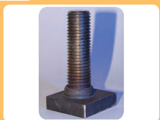
نمونه قطعه جوشکاری شده به روش اصطکاکی
