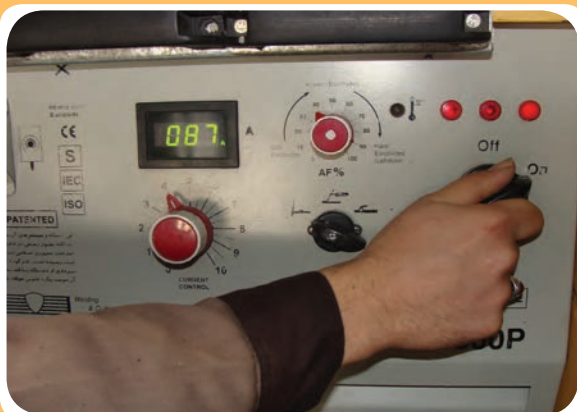
کلیدهای مختلف روی صفحه اصلی رکتی‌فایر جوشکاری
