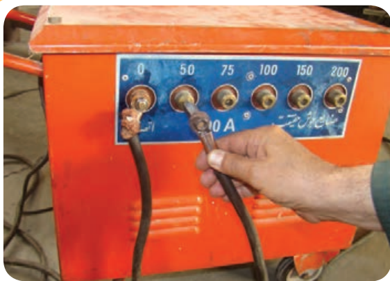
تنظیم آمپر در دستگاه ترانسفورماتور پله‌ای
