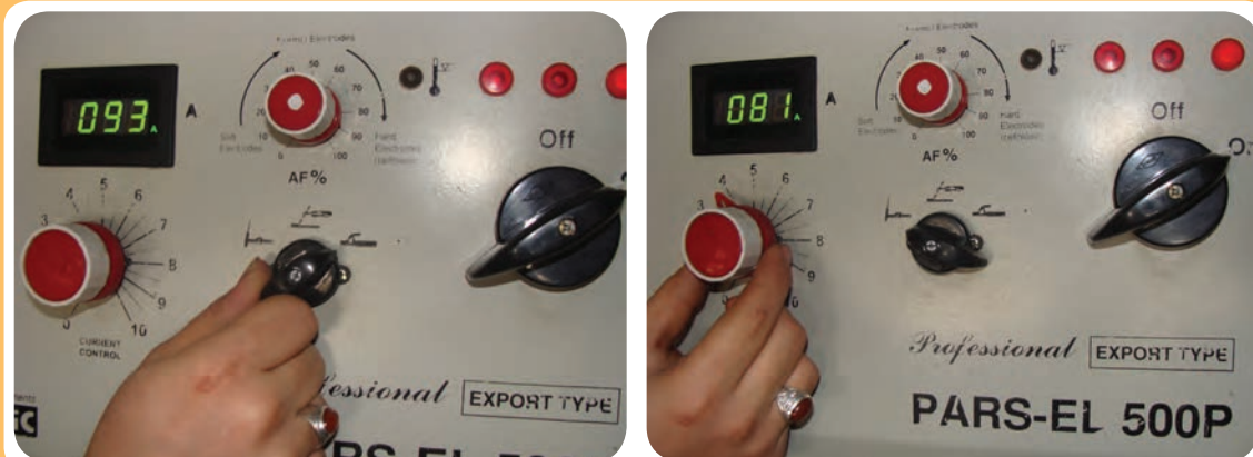
کلیدهای مختلف برای تنظیم دستگاه جوشکاری
