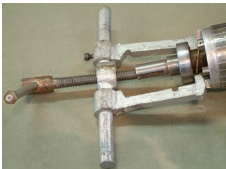
شکل ۴۶-۱ استقرار بلبرینگ کشر روی محور روتور
