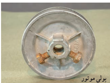
شکل ۱-۲۵- باز کردن پولی موتور
