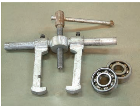
شکل ۴۷-۱ بلبرینگ‌ها پس از جدا شدن از محور
