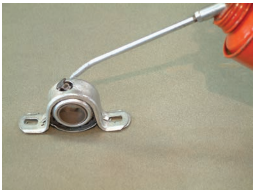
شکل ۱-۳۴- روغن کاری یاتاقان ها
