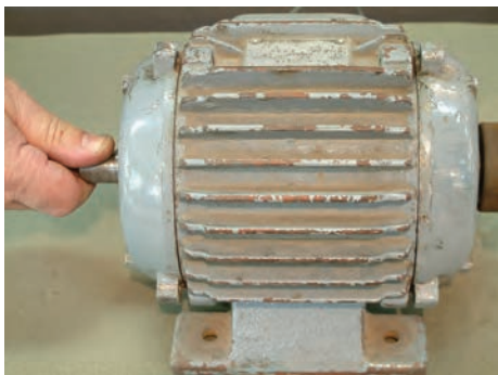
شکل ۴۵-۱ بررسی لقی بوش‌ها
