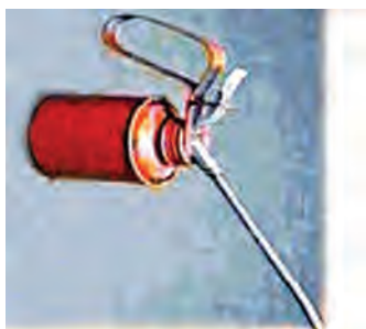
شکل ۱-۳۴- روغن کاری یاتاقان ها
