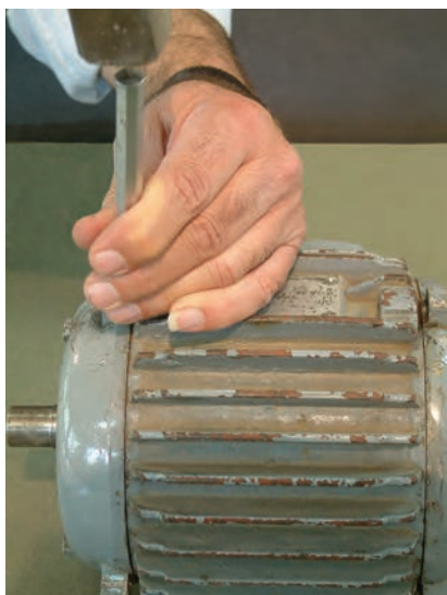
شکل ۱-۲۳- علامت‌گذاری روی پوسته و درپوش‌ها
