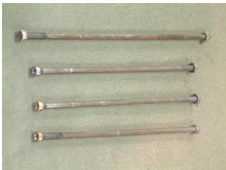
شکل ۱-۴۲ پیچ‌های بلند دو طرف رزوه شده
