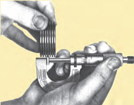
شکل (۲-۴) نحوه در دست گرفتن میکرومتر
