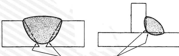
۱۱- مطابق استاندارد DIN، چنان‌چه اتصال در شکل در حالت سطحی انجام شده باشد چه نام دارد؟
