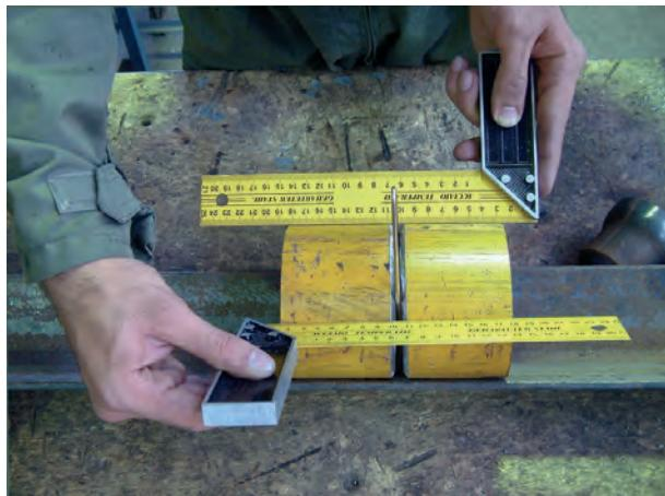
۲- قطعات لوله را درون یک نشی بزرگ طوری قرار دهید که لوله‌ها هم محور باشند، یعنی در یک راستا با هم قرار گیرند، سپس به وسیله‌ی لبه‌ی گونیا هم سطح بودن سطوح جانبی را کنترل کنید و با قراردادن سیم‌جوش در درز لوله فاصله‌ی ریشه را لحاظ کنید (شکل ۱-۴۲).
