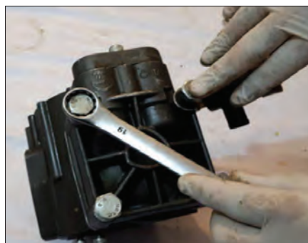
شکل ۴۵- باز کردن درپوش
