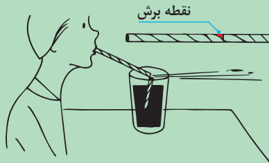
شکل ۹- آزمایش تأثیر اختلاف فشار دو سر یک لوله و مکش ایجاد شده در آن
