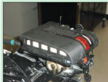
۴- در پوش فیلتر هوا را باز کنید.
