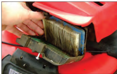
شکل ۱۲- فیلتر هوای کاغذی
