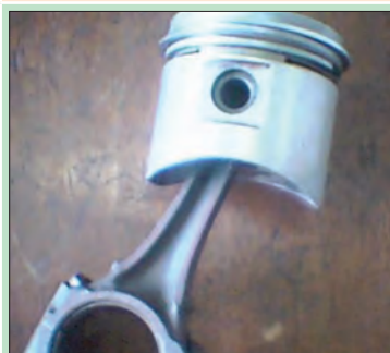
۱۴- پیستون را به طرف بالا هل داده و از سیلندر خارج کنید.
