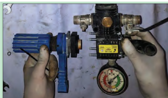
۱- پیچ‌های پوسته را باز کرده و دو قسمت رگولاتور را از هم جدا کنید.
