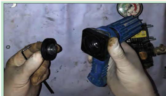
۴- دیافراگم فرسوده را تعویض نموده مجدداً در جای خود قرار دهید. سپس قطعات را عکس مراحل باز کردن مونتاژ کنید.
