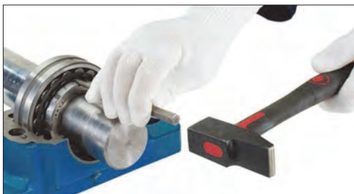
شکل ۶۲- جدا کردن بلبرینگ از بوش از بوش مخروطی
