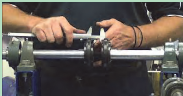
شکل ۷۶- کنترل هم‌راستایی کوپلینگ با استفاده از کولیس
