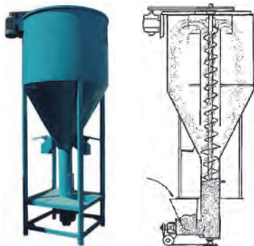
شکل ۷- مخلوط‌کن عمودی و نحوه عملکرد آن
