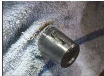
شکل ۸۱-نمونه ای از معایب مربوط به خارها
