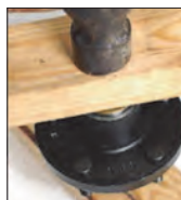
شکل ۷۰- جا زدن کاسه نمد
