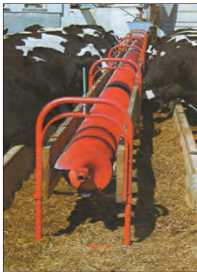
شکل ۲۲- توزیع خوراک به وسیله نقاله پیچی
