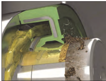
شکل ۶۸- کاسه نمد و نحوه عمل آن
