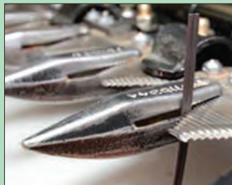
شکل ۶۴ - تأثیر زیاد بودن فاصله لب انگشتی
