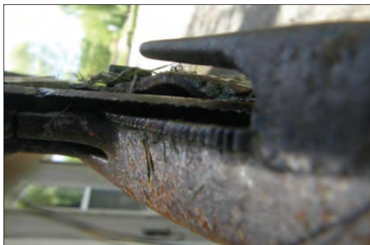
شکل ۵۴- فاصله بین لبه برنده تیغه و لبه برنده انگشتی
