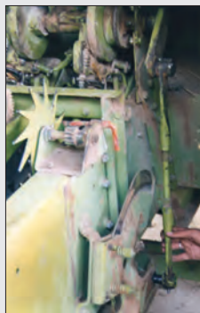
شکل ۶۵- برداشتن میله رابط
