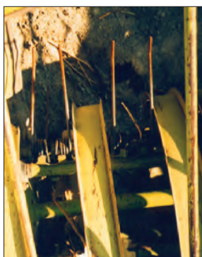
شکل ۹- پایه انگشتی شکسته
