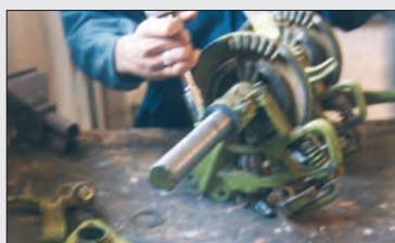
شکل ۷۶- پیاده کردن محور گره‌زن و اجزای آن
