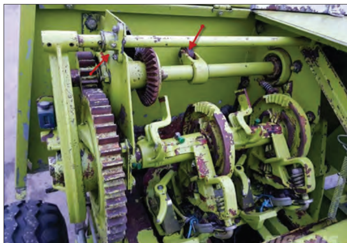
شکل ۷۵- یاتاقان‌ها و نگهدارنده فرمان‌دهنده گره‌زن
