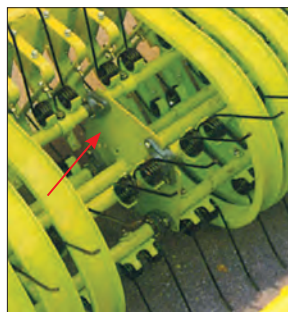
شکل ۱۶- یاتاقان محور انگشتی و محل نصب آن
