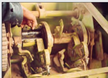
شکل ۴۶- برداشتن پوسته گره زن
