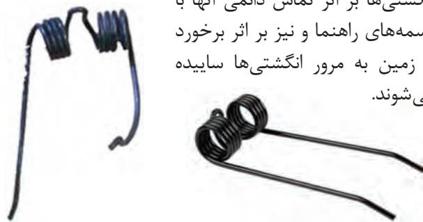
شکل ۴- تفاوت انگشتی سالم و انگشتی معیوب
