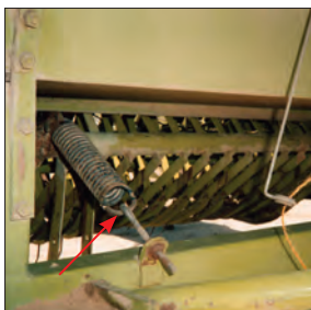
شکل ۲۶- فنر شاسی بردارنده
