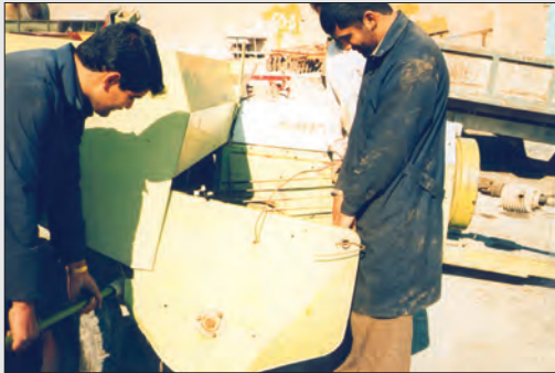
شکل ۳۳- جدا کردن واحد بردارنده
