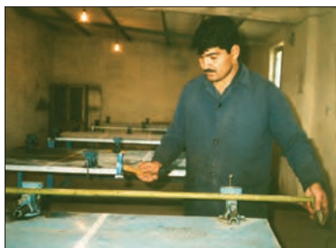
شکل ۱۱- صاف کردن محور انگشتی
