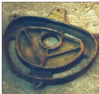
شکل ۱۸- صفحه بادامکی معیوب
