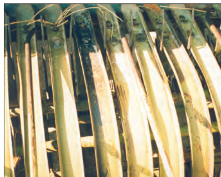
شکل ۶- ساییده شدن انگشتی‌ها به تسمه‌های راهنما
