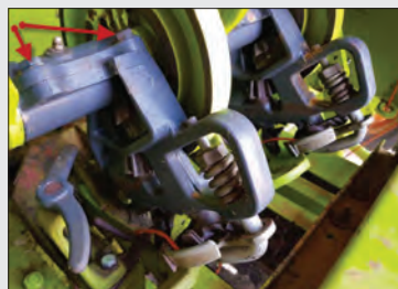
شکل ۴۵- پیچ‌های پوسته گره زن
