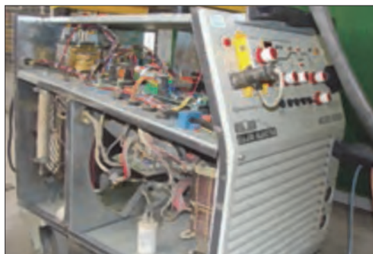
شکل ۱۱- ساختمان داخلی رکتیفایر
