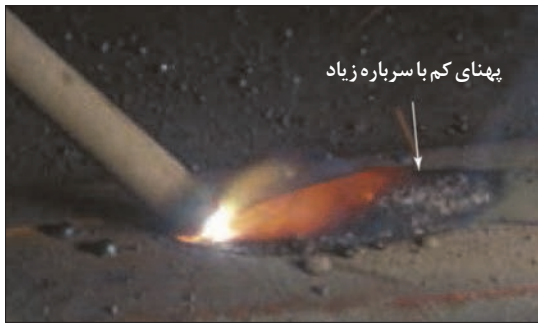
شکل ۳۰- جوشکاری با طول قوس بسیار کم
