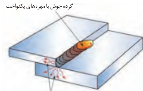
شکل ۴۶- الگوی J شکل اجازه می‌دهد تا گرما روی قطعه ضخیم‌تر متمرکز شود
