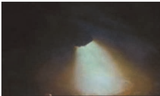
شکل ۳۱- جوشکاری با طول قوس بسیار زیاد
