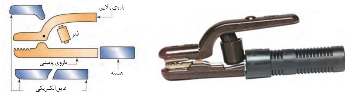
شکل ۱۷- انبر الکتروود و قسمت های قابل تعویض آن
