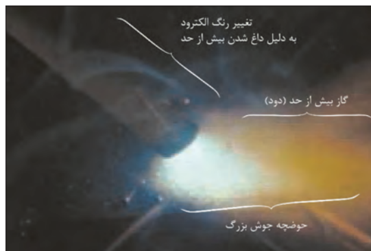
شکل ۲۷- جوشکاری با آمپر بسیار بالا
