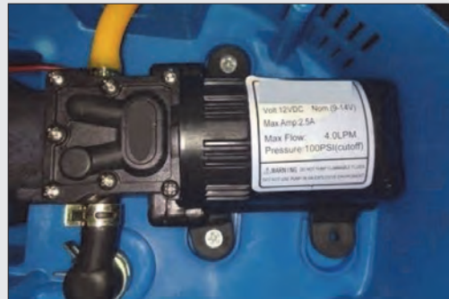
شکل ۳۲- اتصال پمپ و رعایت جهت حرکت سیال
