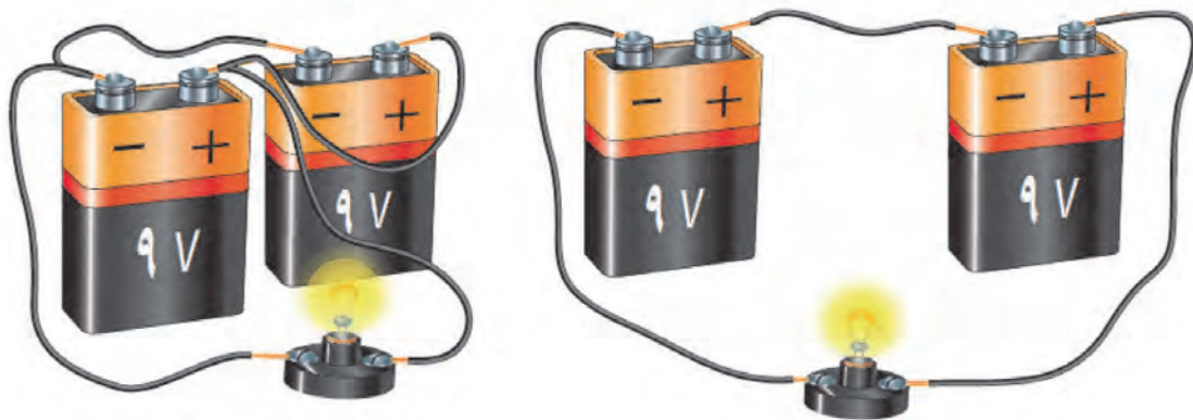
شکل ۱۵- اتصال سری و موازی پیل الکتریکی
