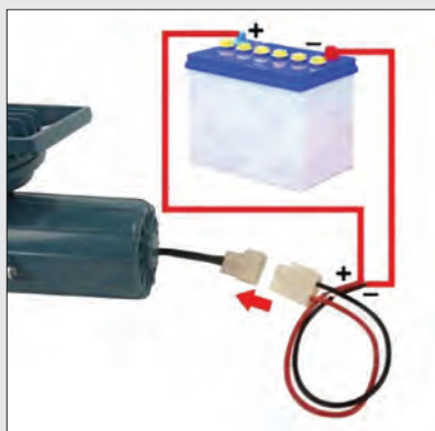
شکل ۴۲- اتصال پمپ با سوکت به باتری
