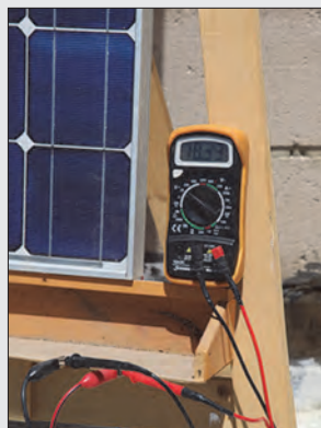
شکل ۲۲- اندازه‌گیری ولتاژ بی‌باری
