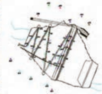
شبکه میکروژئودزی روی بدنه سد
