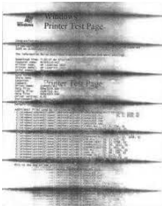
شکل ۱-۳۹- چاپ سیاه به دلیل خرابی کارت‌تریج
