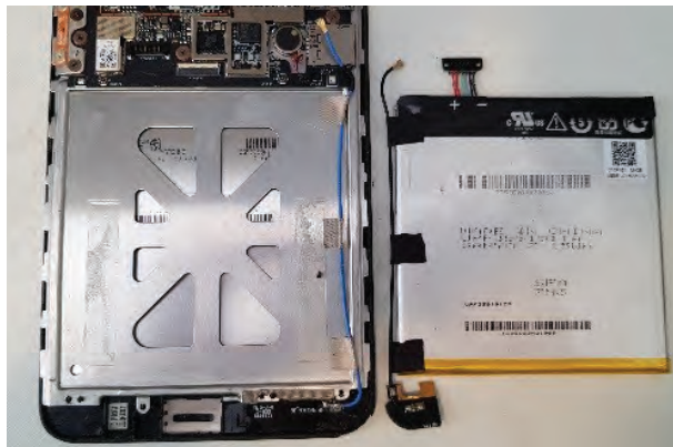
شکل ۳۰-۵- جدا کردن باتری از بدنه اصلی
