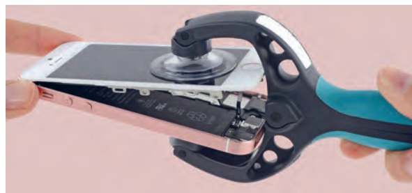
شکل ۵-۳۵- جدا کردن صفحه لمسی با ابزار وکیوم
