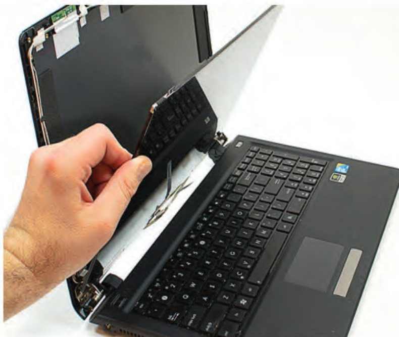
شکل ۵-۲۲- باز کردن نمایشگر لپ‌تاپ
