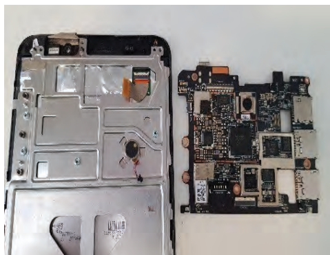
شکل ۵-۳۳- جدا کردن کامل برد از بدنه
