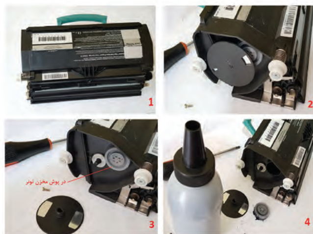
شکل ۴۸-۳- مراحل شارژ یک نمونه کارت‌تریج لیزری
