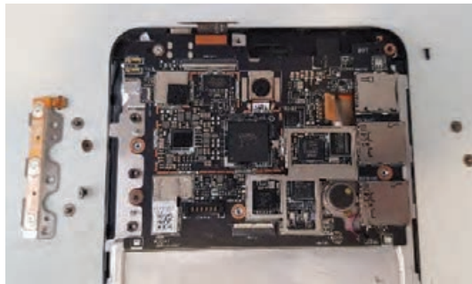
شکل ۳۱-۵- باز کردن پیچ‌های اتصال دهنده برد به بدنه
