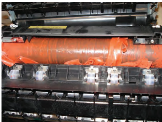
شکل ۳-۳۶- غلتک پرس معیوب
