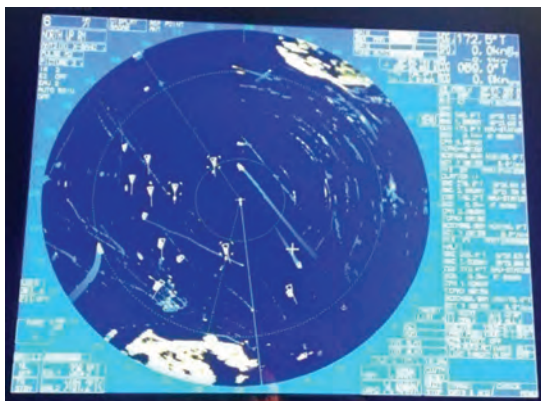
شکل ۳۱- تصویری از یک نمایشگر رادار نوبری
