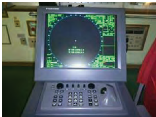
شکل ۳۱- تصویری از یک نمایشگر رادار نوبری
