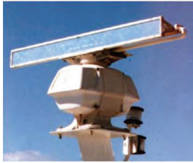
شکل ۲۸- آنتن رادار و رادم برای محافظت قسمت چرخنده آنتن رادار
