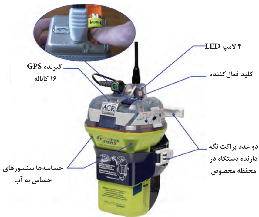
شکل ۱۳- اجزای مختلف دستگاه EPIRB
