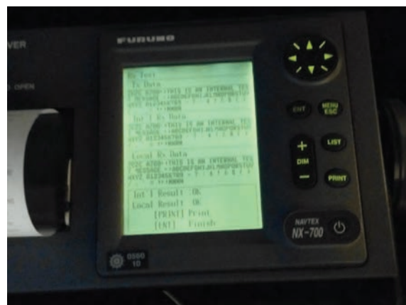
شکل ۴۴- آزمون دریافت کنندگی (RX) دستگاه NAVTEX
