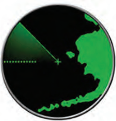
شکل ۱۷- صفحه رادار در حال دریافت ۱۲ پالس برگشتی از RADAR SART در فاصله بالای ۱ مایل
