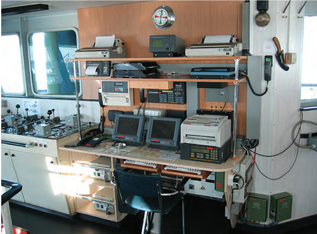
شکل ۸- تجهیزات GMDSS در کشتی
