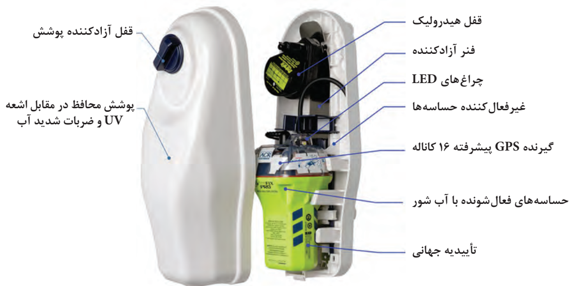
شکل ۱۱- اجزای تشکیل دهنده دستگاه EPIRB
