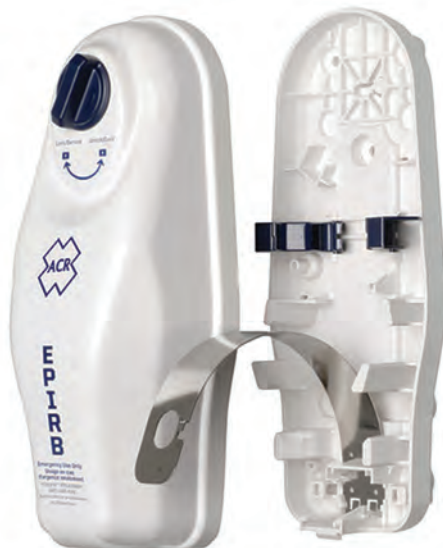
شکل ۱۲- دستگاه EPIRB پس از عملکرد قفل هیدرو استاتیک و فنر داخلی
