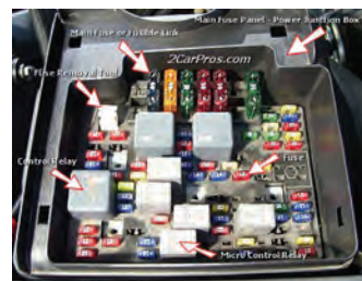
فیوز روی بُرد الکترونیکی
