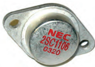
ترانزیستور قدرت با بدنه فلزی
