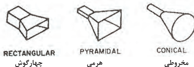
شکل ۳۱- رادیاتورهای بوقی
