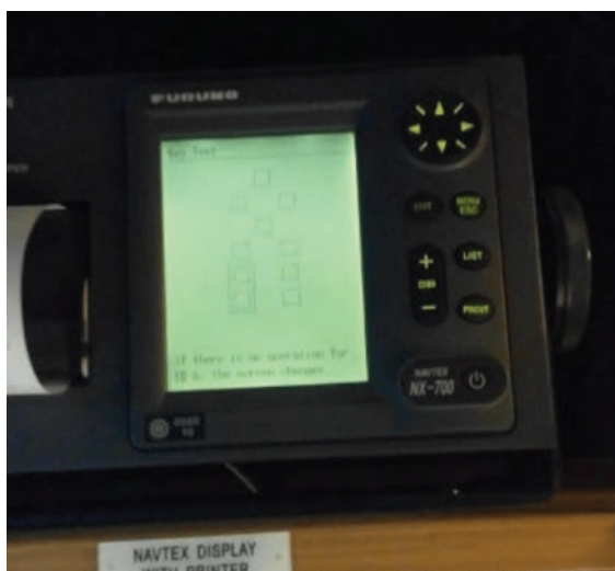
شکل ۴۳- آزمایش کلیدهای دستگاه NAVTEX
