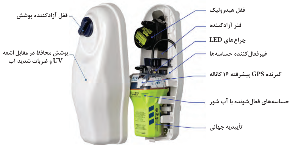
شکل ۱۱- اجزای تشکیل دهنده دستگاه EPIRB
