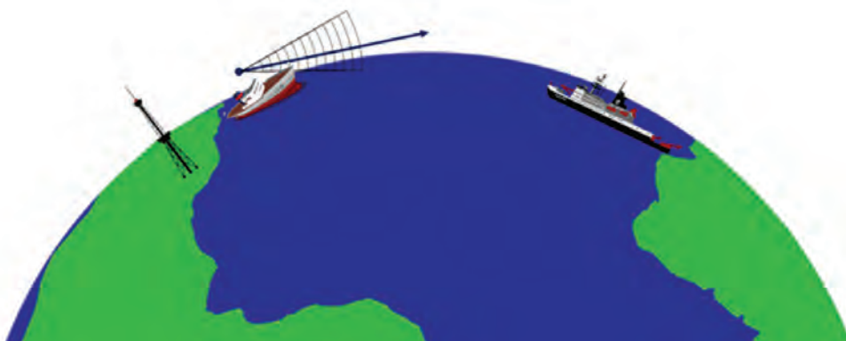
شکل ۷- انحنای زمین و ناتوانی آنتن‌های VHF در دیدن همدیگر
