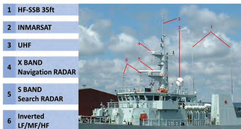
شکل ۱۷- موقعیت نصب آنتن‌ها در کشتی
