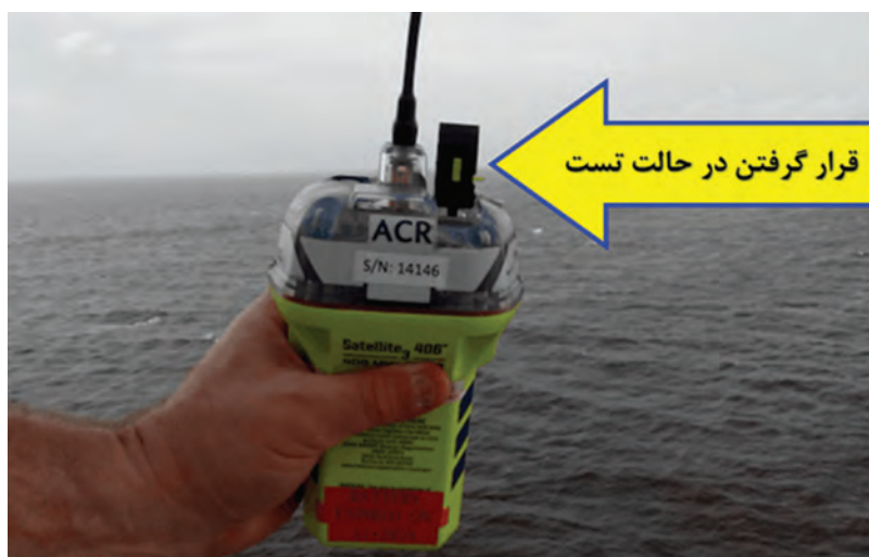
شکل ۳۷- قراردادن دستگاه EPIRB در حالت تست
