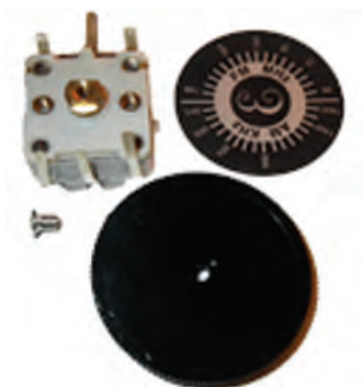
خازن متغیر و اجزای آن
