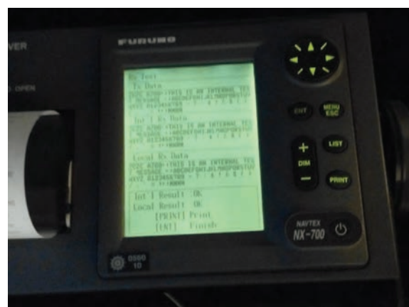
شکل ۴۴- آزمون دریافت کنندگی (RX) دستگاه NAVTEX
