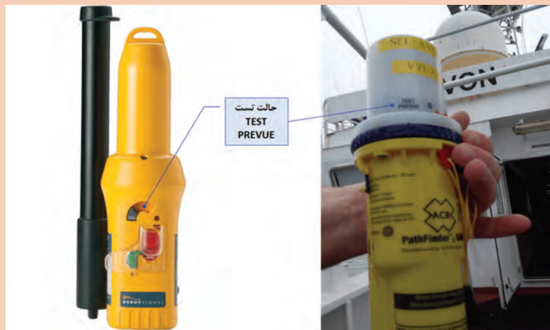
شکل ۳۸- تست دستگاه SART
