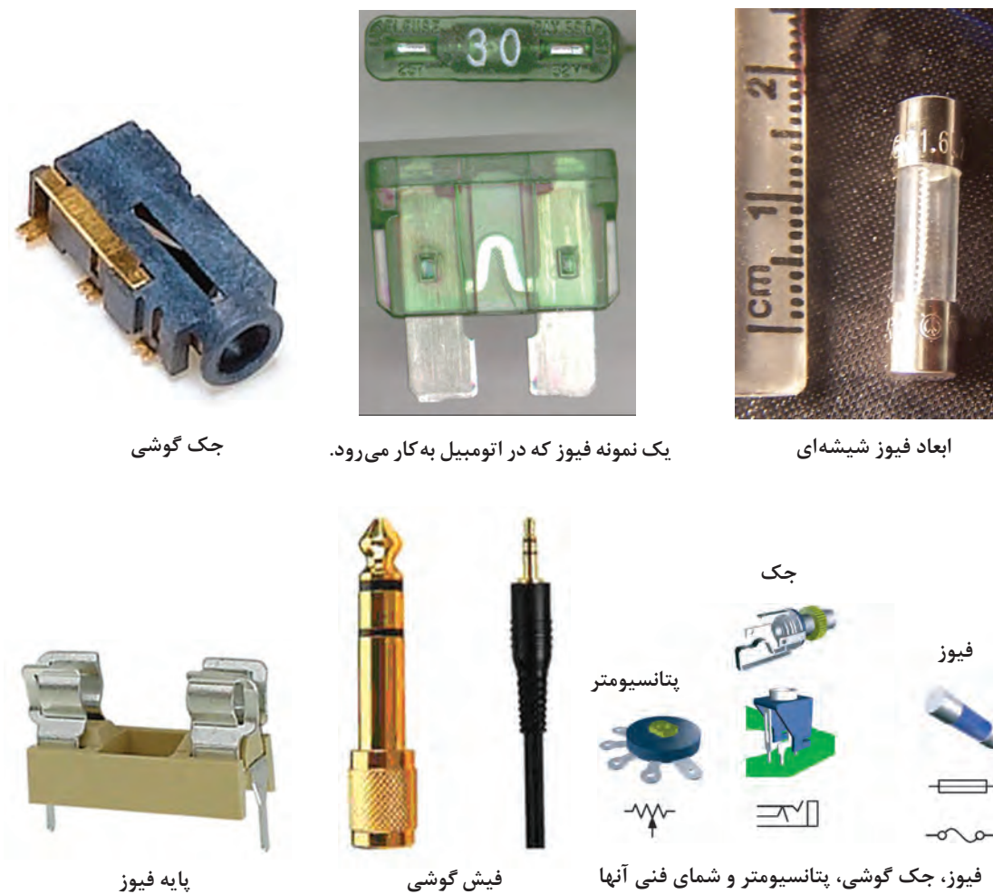
شکل ۹- شمای فنی و شکل ظاهری تعداد دیگری از قطعات الکترونیکی
