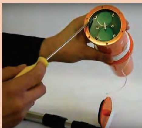
شکل ۴۰- تعویض باتری دستگاه SART
