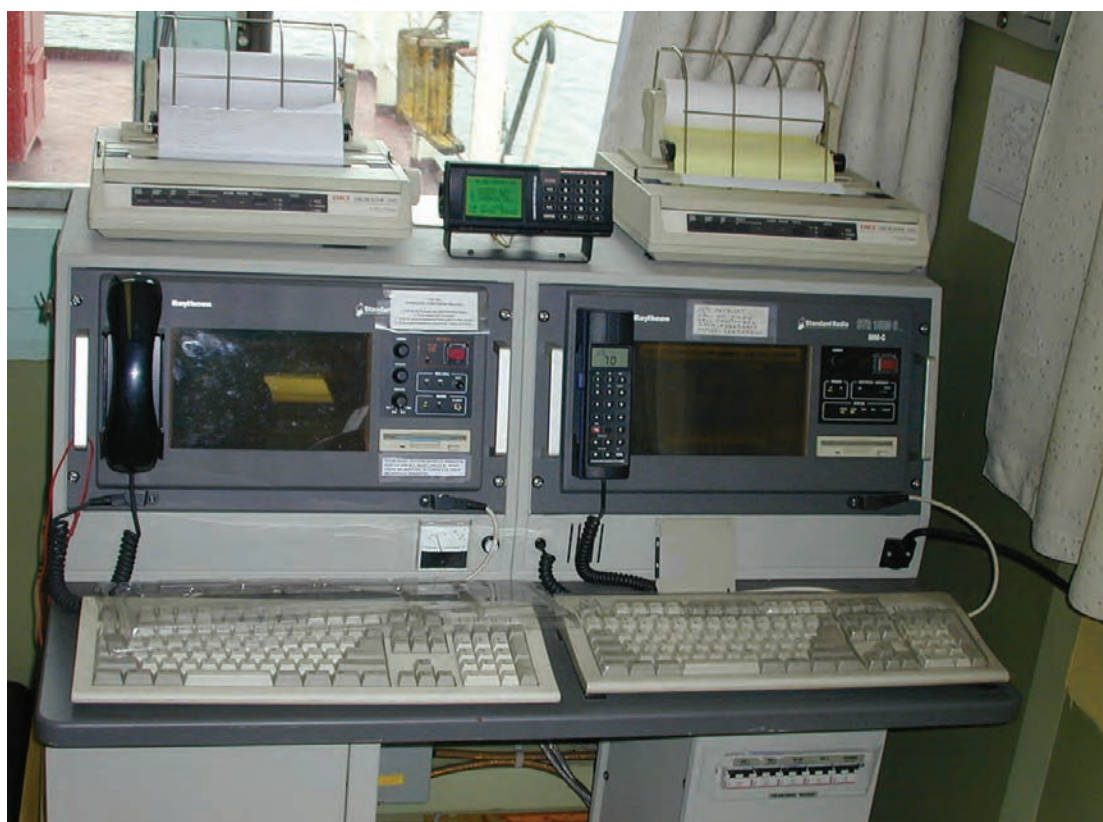
شکل ۷- دستگاه NAVTEX از تجهیزات GMDSS
