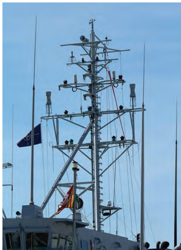
شکل ۳۲- محل نصب چراغ‌ها ناوبری
