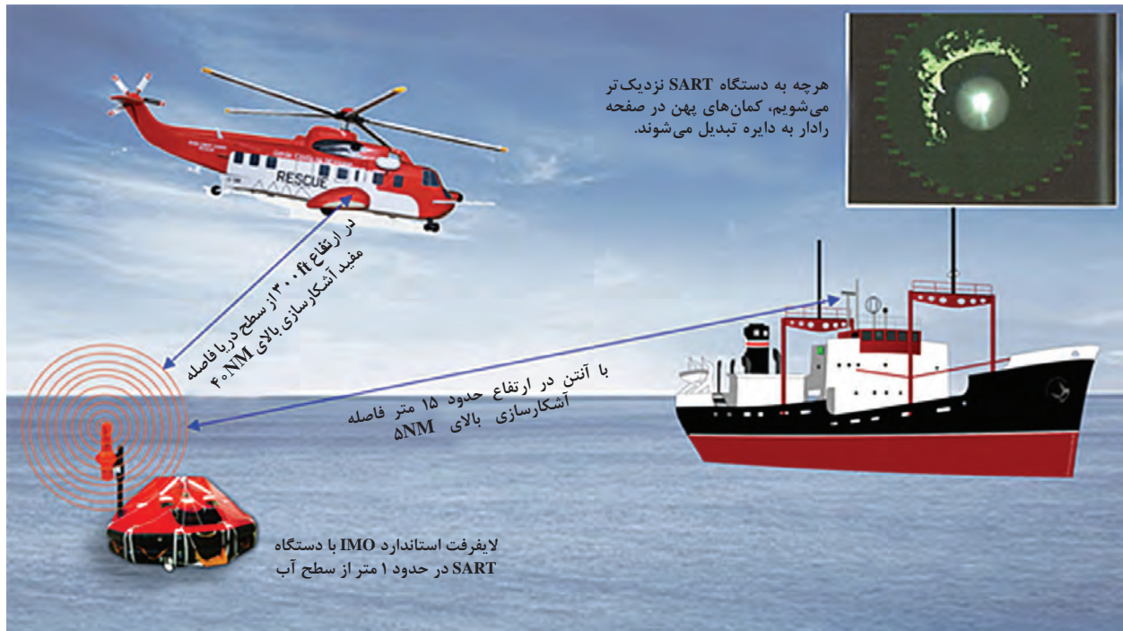
شکل ۲۰- عملکرد دستگاه RADAR SART
