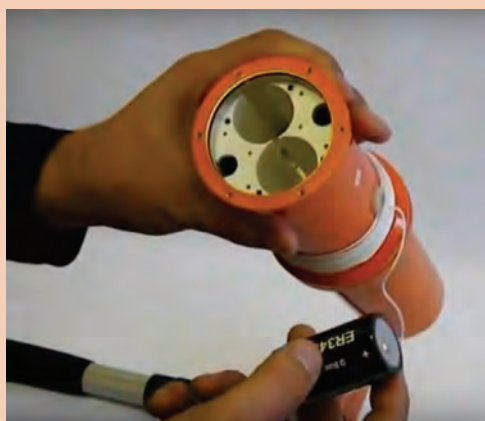
شکل ۴۰- تعویض باتری دستگاه SART
