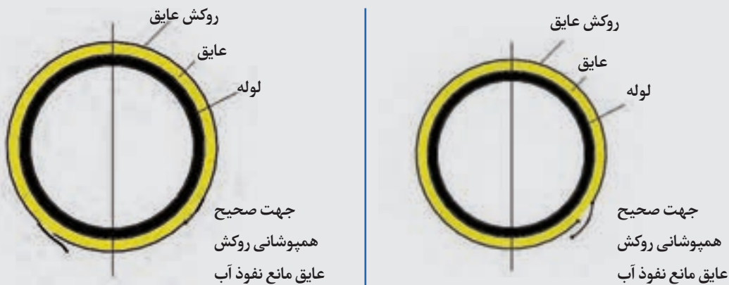
شکل ۶- جهت صحیح روکش عایق
