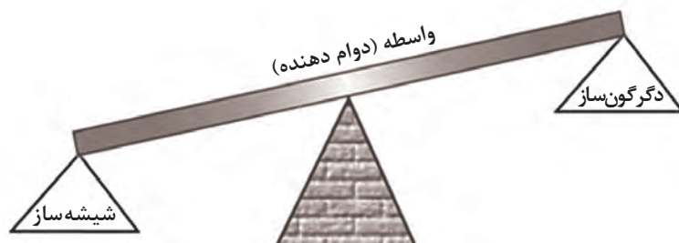
شکل ۱۳- کنترل خواص شیشه با افزودن مواد واسطه
