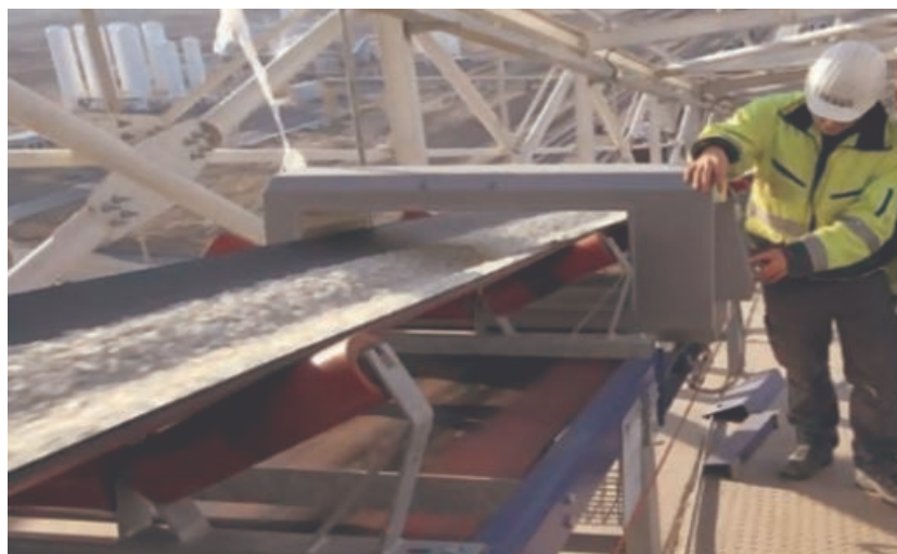
شکل ۳۱- فرایند آهن‌گیری هنگام انتقال مواد پودر شده
