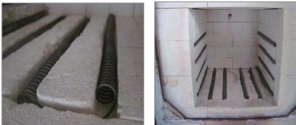
شکل ۱۳- نصب المنت درون شیار
