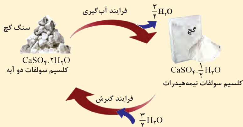
شکل ۳۵- فرایند گیرش و جذب آب در گچ
