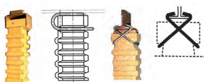
شکل ۴۲- برخی از واسطه‌های فلزی برای اتصال انکرهای سرامیکی به جداره
