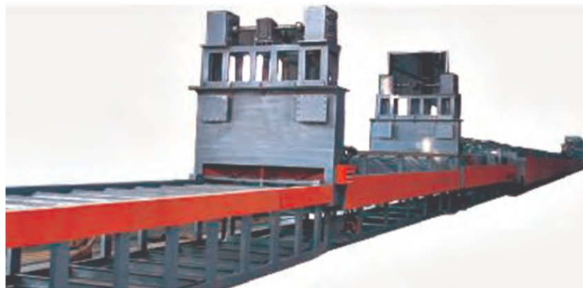
شکل ۱۲- کوره رولری برای عملیات تمپر حرارتی
