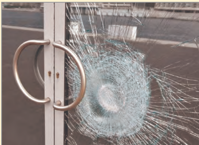
شکل ۳۹- شیشه‌ی طلقی (لمینیت) پس از شکسته شدن
