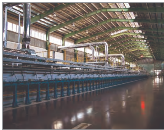
شکل ۳۰- گرمخانه تنش زدایی شیشه
