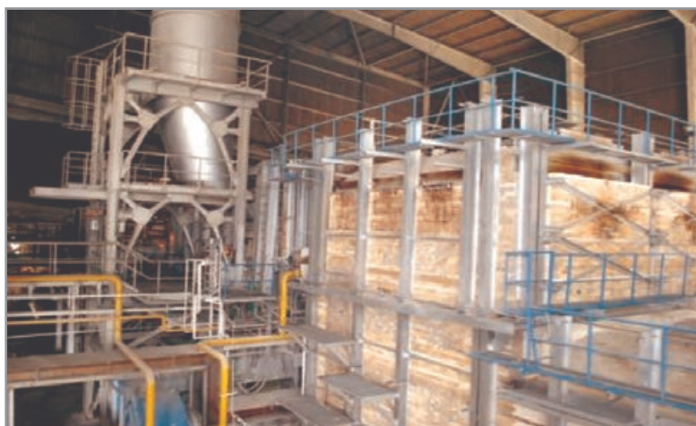
شکل ۳۶- کوره و سیلوی خوراک دهنده
