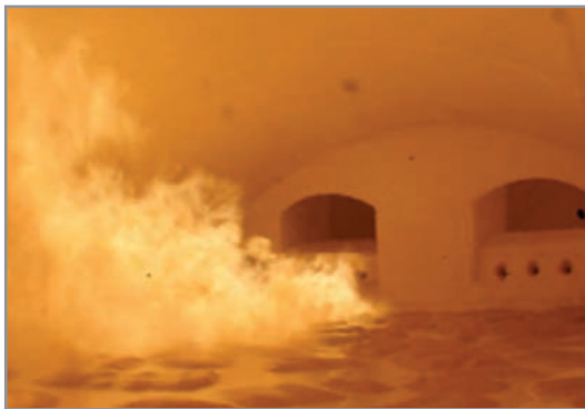
الف) مخزن ذوب کوره ریجنراتوری پشت گذر
