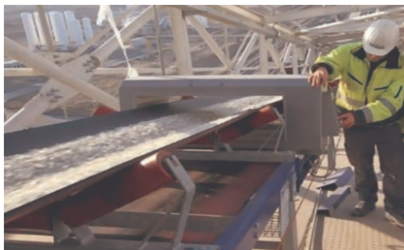
شکل ۳۱- فرایند آهن‌گیری هنگام انتقال مواد پودر شده
