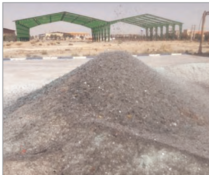
شکل ۳۹- آمیز شیشه‌ی سودا-آهکی تهیه شده از خرده شیشه
