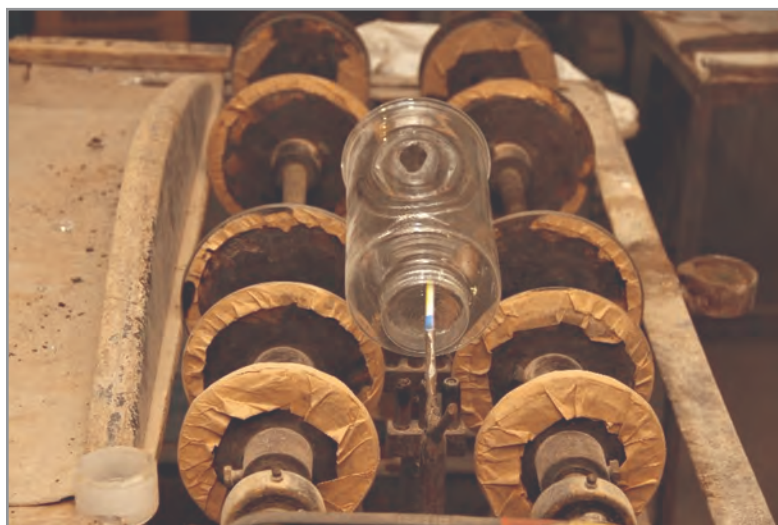
شکل ۳۰- دستگاه برش حرارتی
