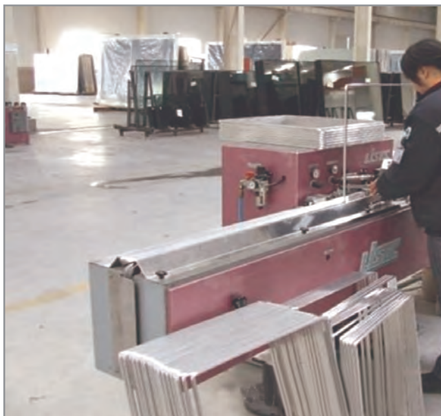
شکل ۴۴- کارگر در حال آماده سازی فاصله انداز
