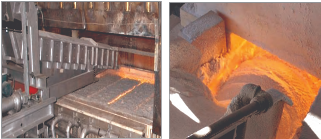
شکل ۲۳- ریختن آمیز به درون کوره
