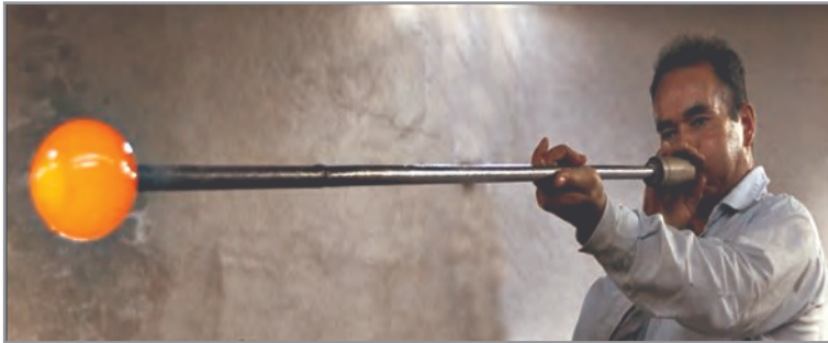
شکل ۵- ایجاد حباب در لقمه مذاب با دمیدن
