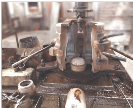
شکل ۱۳- قالب پرس بادی
