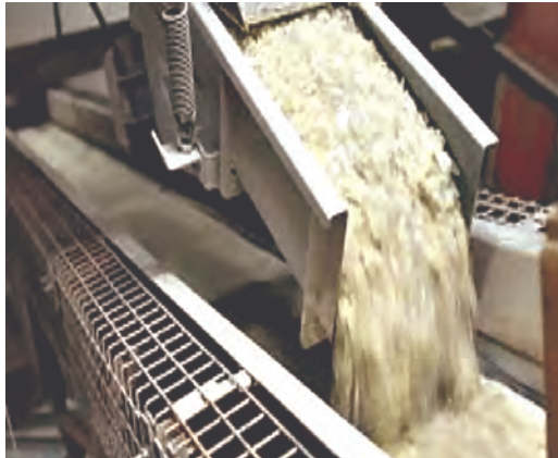
شکل ۲۶- خردایش و آهن‌گیری مواد اولیه
