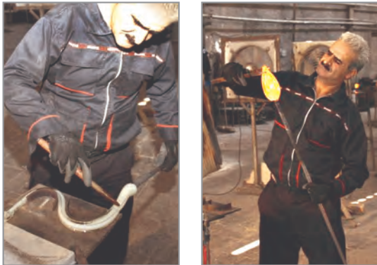
شکل ۷- شکل‌دهی گوی با کمک ابزار
