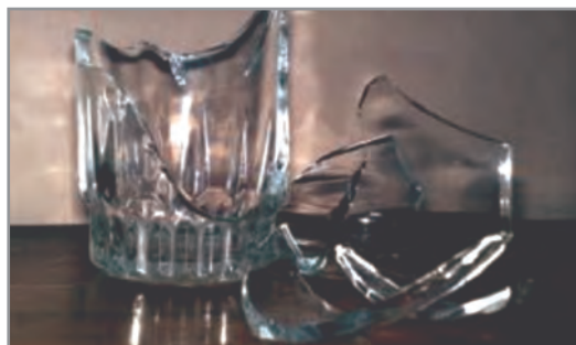
شکل ۸- شکستن شیشه سرد با ریختن مایع داغ
