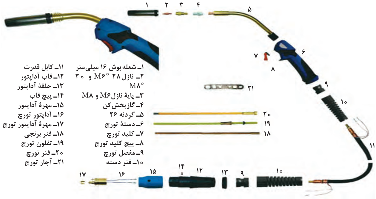
شکل ۷- اجزای تشکیل دهنده تورچ GMAW
