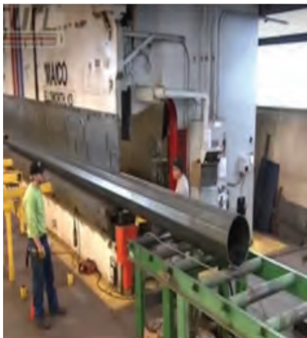
شکل ۱۶: دستگاه برک پرس با جابه‌جایی هوشمند قطعات برای ساخت تیر چراغ برق
