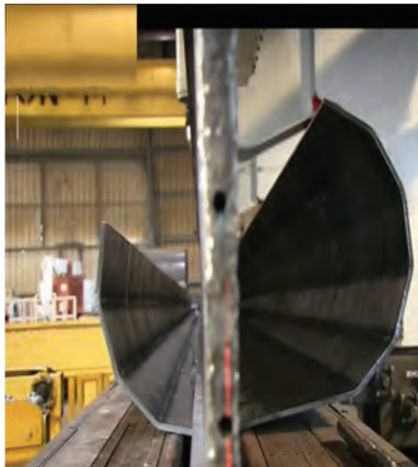
شکل ۱۶: دستگاه برک پرس با جابه‌جایی هوشمند قطعات برای ساخت تیر چراغ برق
