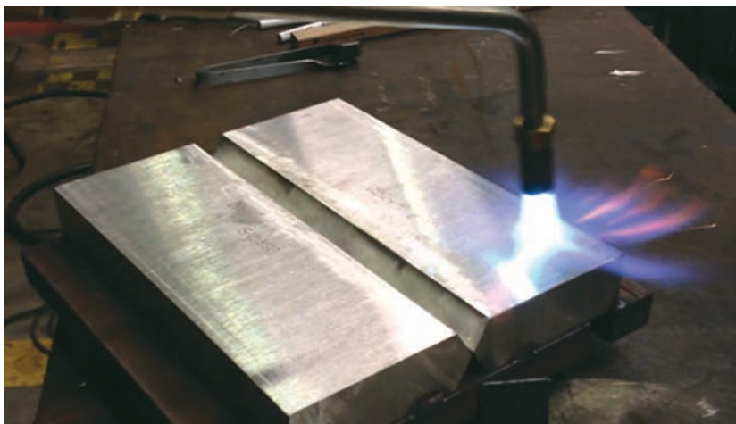
شکل ۵- پیش گرم کردن قطعه ضخیم توسط شعله
