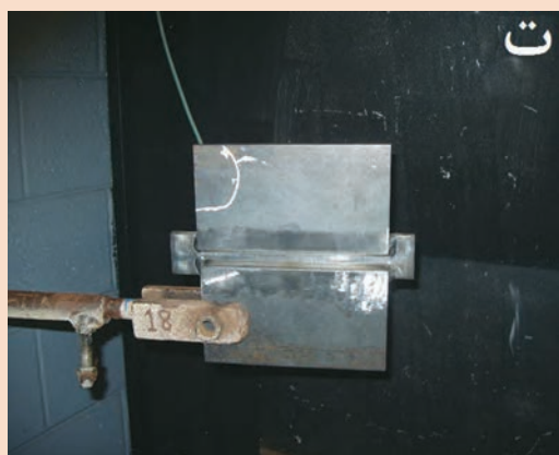
شکل ۱۷- موقعیت دهی و مونتاژ قطعه کار
