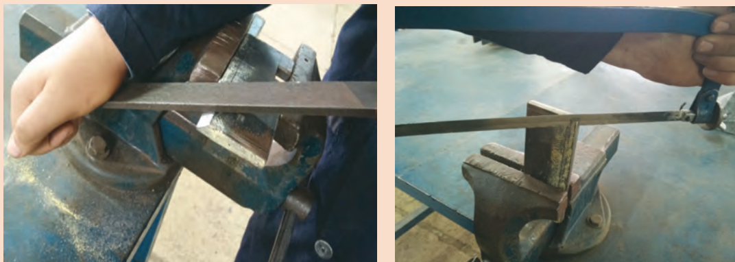
شکل ۱۵-اره کاری و سوهان کاری ورق برای ایجاد پخ ۴۵ درجه
