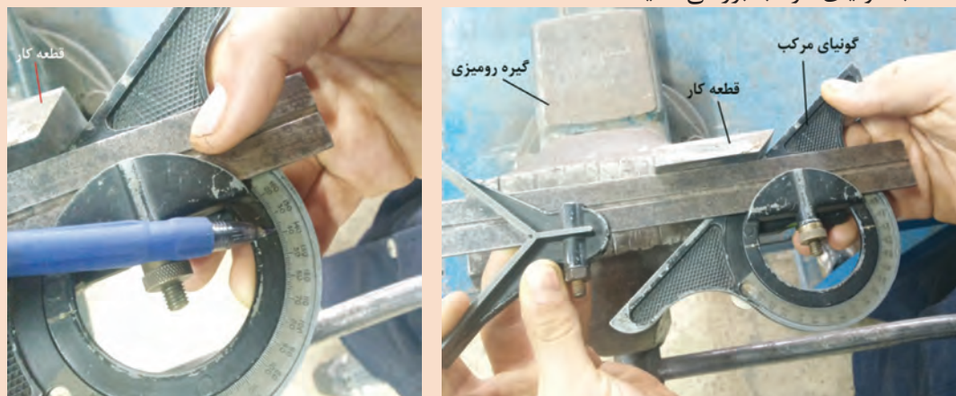
شکل ۲۳- بررسی صحت زاویه با گونیای مرکب
