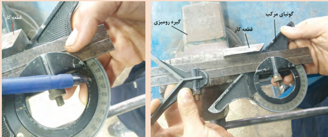
شکل ۲۰- بررسی صحت زاویه با گونیای مرکب
