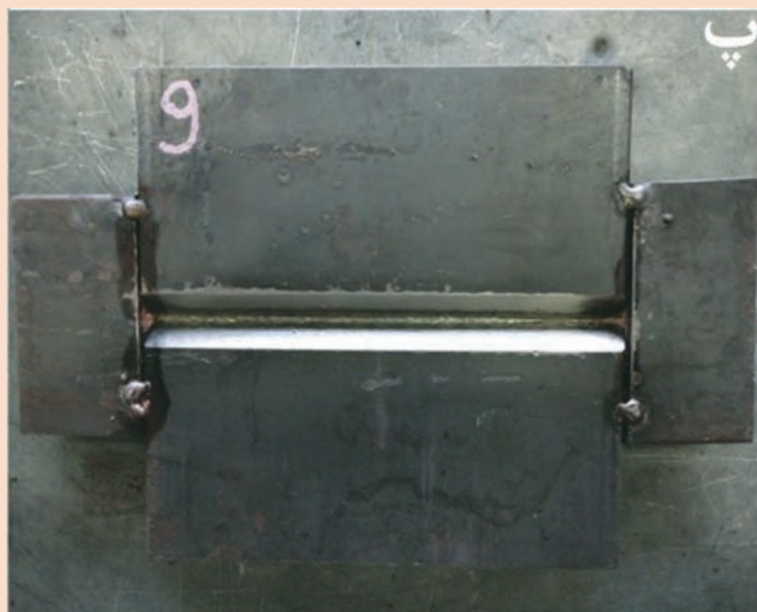
شکل ۲۱- موقعیت دهی و مونتاژ قطعه کار
