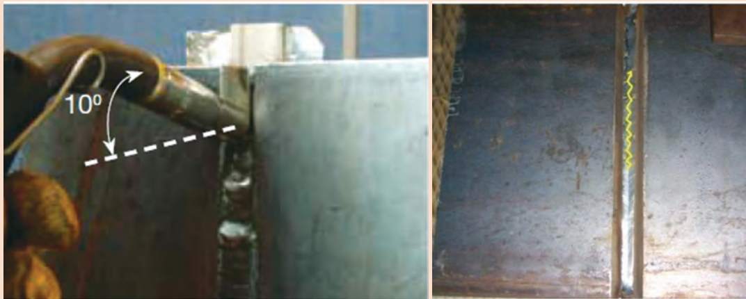
شکل ۲۴- زاویه تورچ و جهت حرکت آن
