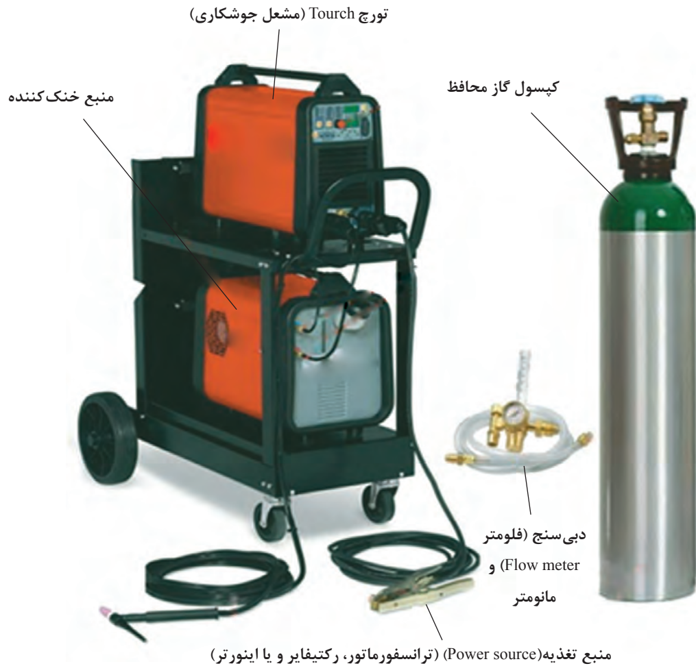
شکل ۲- تجهیزات فرآیند GTAW
