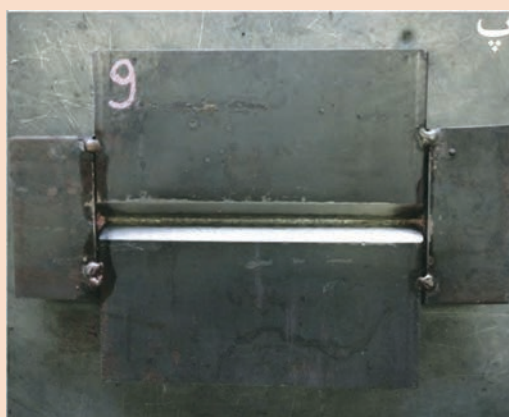
شکل ۱۷- موقعیت دهی و مونتاژ قطعه کار
