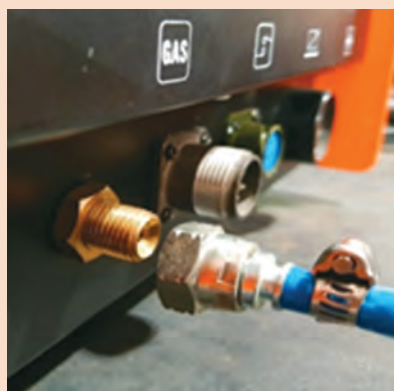
شکل ۶- نصب اتصال گاز محافظ
