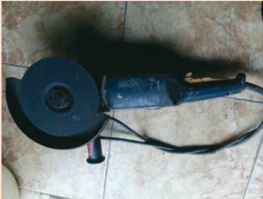
شکل ۱۳- طرز صحیح قرار دادن دستگاه سنگ زنی روی میز کار
