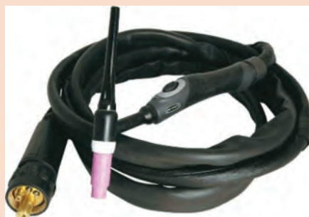
شکل ۸- کابل اتصال مرکزی
