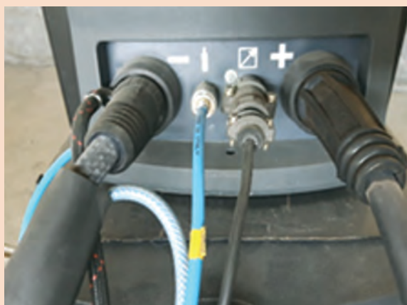
شکل ۹- کابل اتصال سوئیچی
