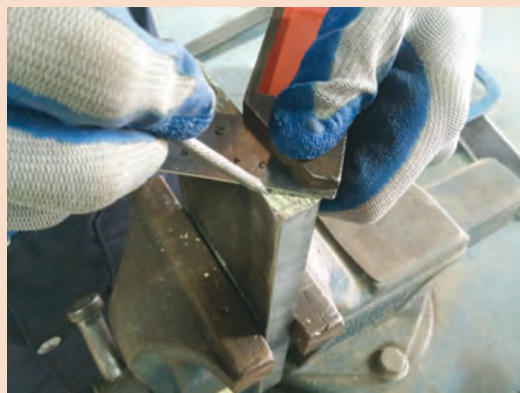
شکل ۱۴- رسم زاویه ۴۵ درجه توسط سوزن خط‌کش و گونیای فلزی
