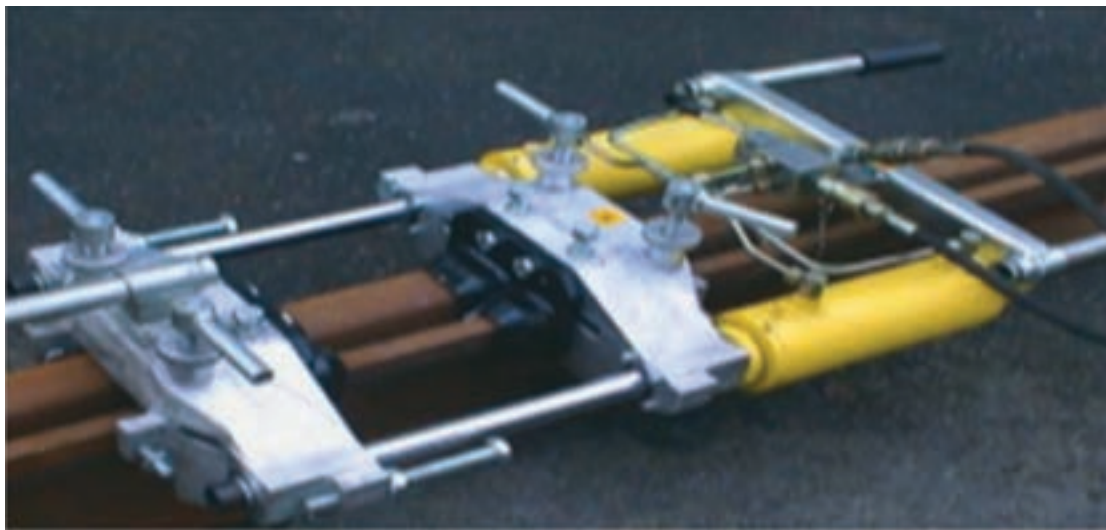
شکل ۱۲- ماشین هیدرولیک برش گرده اضافه جوش
