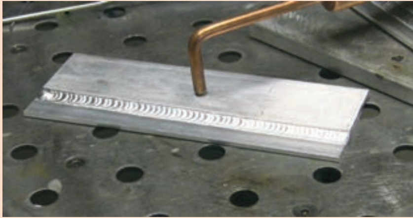
شکل ۱۸- اتصال لب روی هم نهایی
