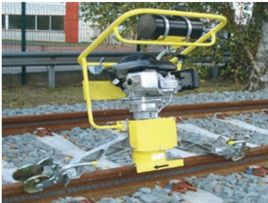
شکل ۱۳- ماشین اتوماتیک سنگ زنی گرده اضافی جوش
