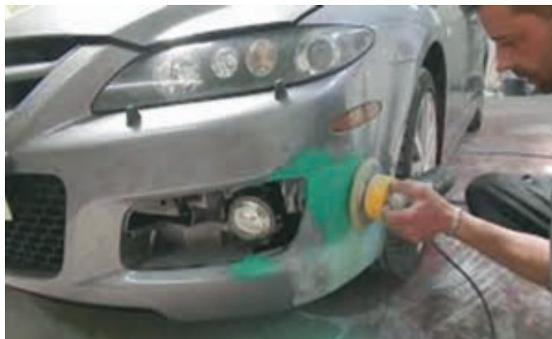
شکل ۲۸- تمیزکاری سپر خودرو
