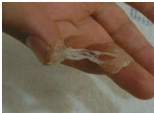
شکل ۳۶- جداکردن پلاستیک ذوب شده از انگشتان دست و خطر چسبیدن مجدد آن
