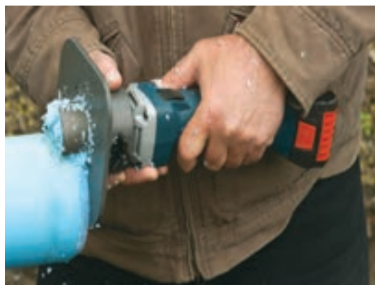
شکل ۲۵- پخ زدن قطعات پلاستیکی برای جوشکاری
