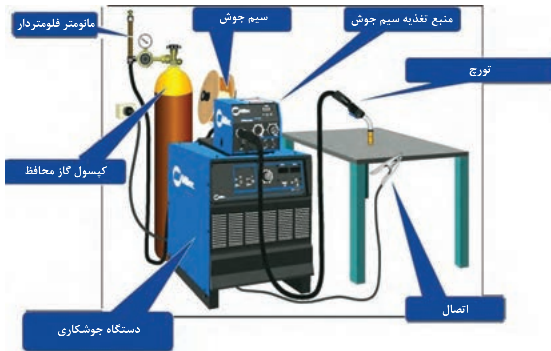
شکل ۶- قسمت های مختلف دستگاه جوشکاری FCAW
