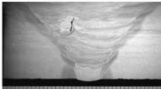
شکل ۳۳- ترک‌های داخلی درون جوش
