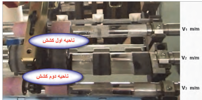
شکل ۲۳- نواحی کشش در رینگ
