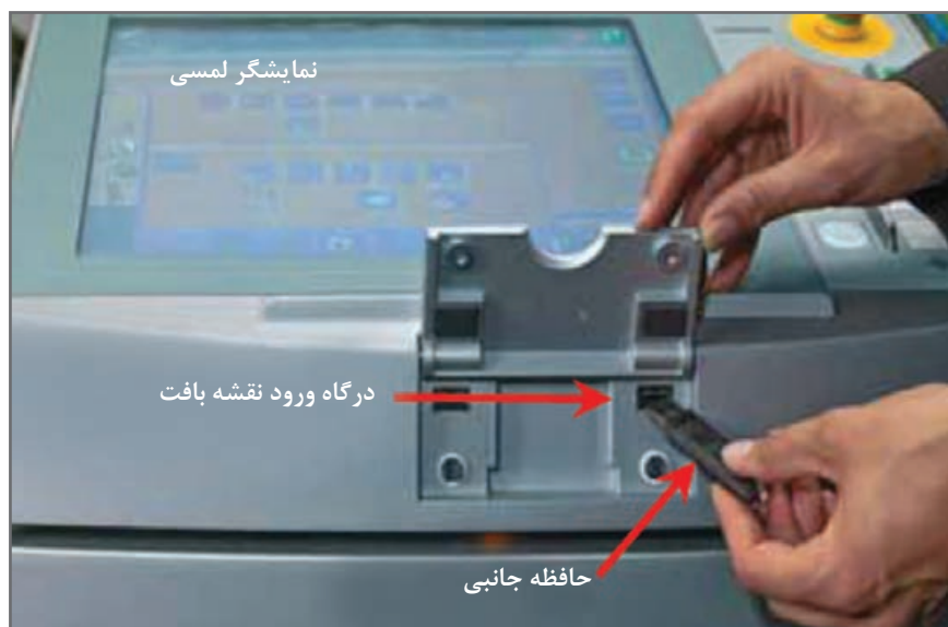
شکل ۳۵- نحوه اتصال حافظه جانبی به ماشین بافندگی
