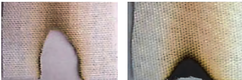
شکل ۱۶- عکس‌العمل نمونه پارچه خام و عمل شده با مواد نانویی تأخیرانداز شعله
