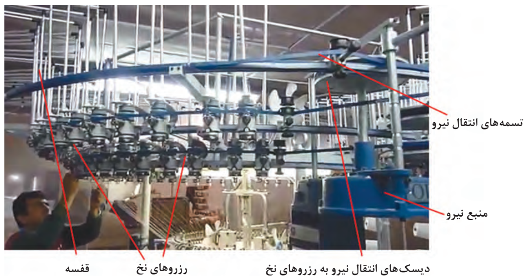
شکل ۲۸- انتقال نیرو از ماشین به تغذیه‌کننده نخ روی قفسه
