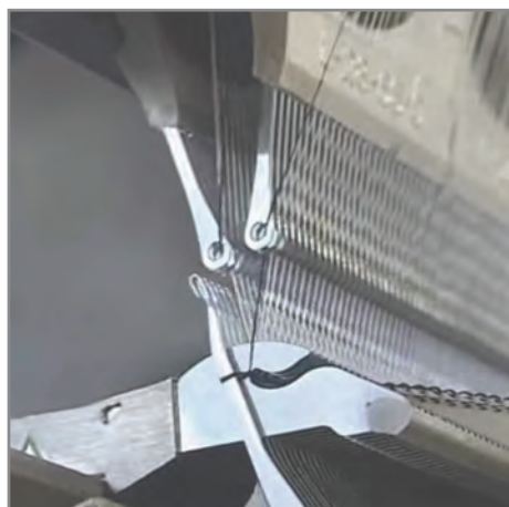
شکل ۳۸- مرحله آندرلپ حرکت شانه پشت سوزن
