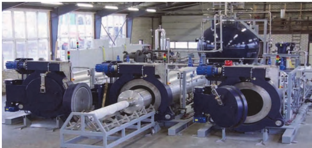
شکل ۲۵- یک نمونه ماشین رنگری فوق بحرانی CO ۲
