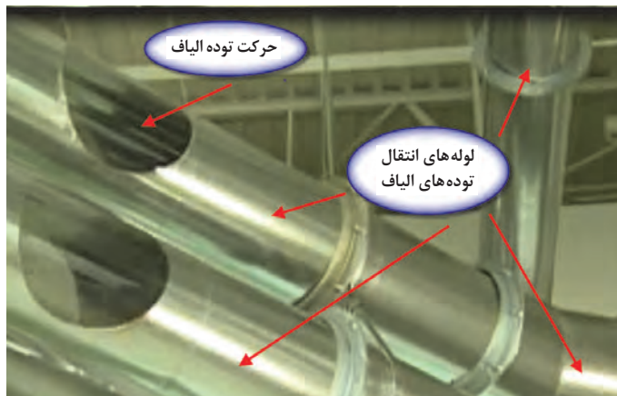
شکل ۸- لوله‌های انتقال الیاف در سیستم شوت فید
