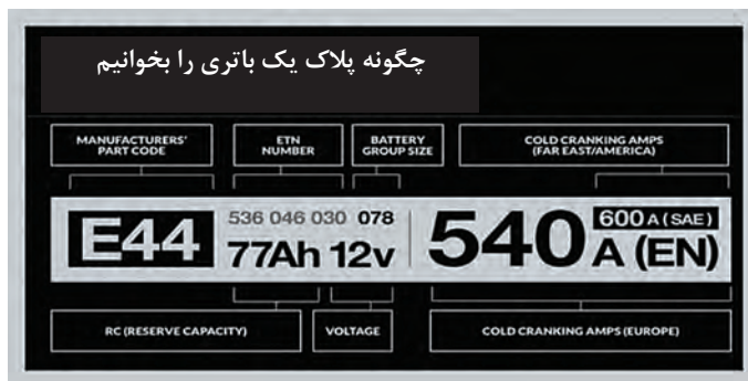
شکل ۴۴- دو نوع پلاک باتری و روش خواندن آن
