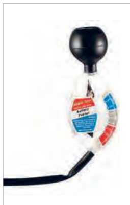
هیدرومتر، اندازه‌گیری جرم حجمی الکترولیت
