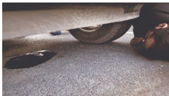
تصویر خودروی دارای نشستی سوخت یا روغن
