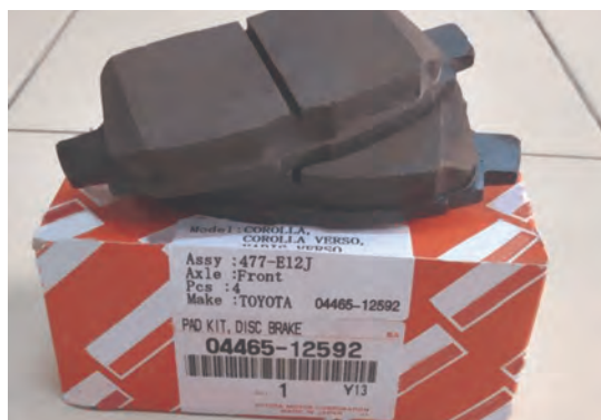
شکل ۶- نمونه‌ای از روش درج شماره فنی
