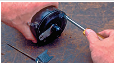
- باز کردن پیچ‌های اتصال درپوش به بدنه استارتر
