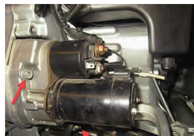
باز کردن پیچ‌های اتصال استارت به موتور
