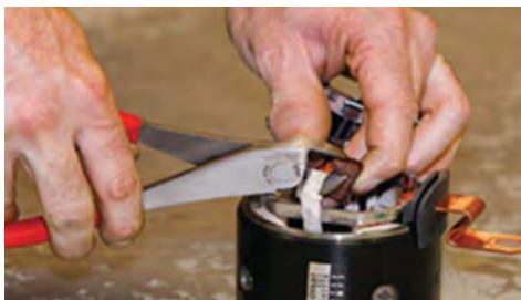
شکل ۹۹ – برخی نکات لحیم کاری زغال‌های استارتر
