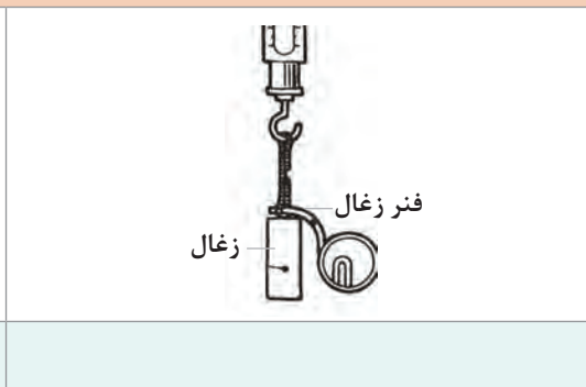
- بررسی عایق بودن پایه‌های زغال مثبت
