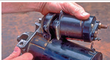
- خارج کردن اتوماتیک استارتر
