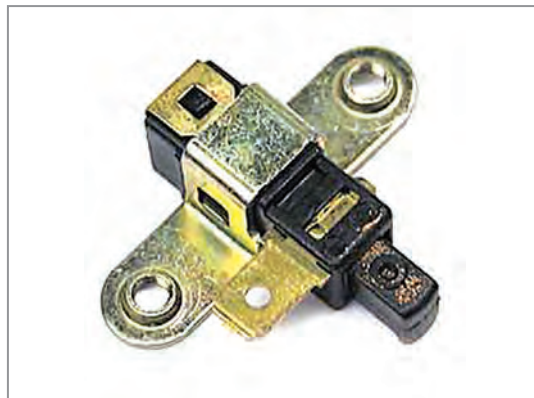
شکل ۲۴- میکروسوییچ ترمز دستی و محل بستن آن
