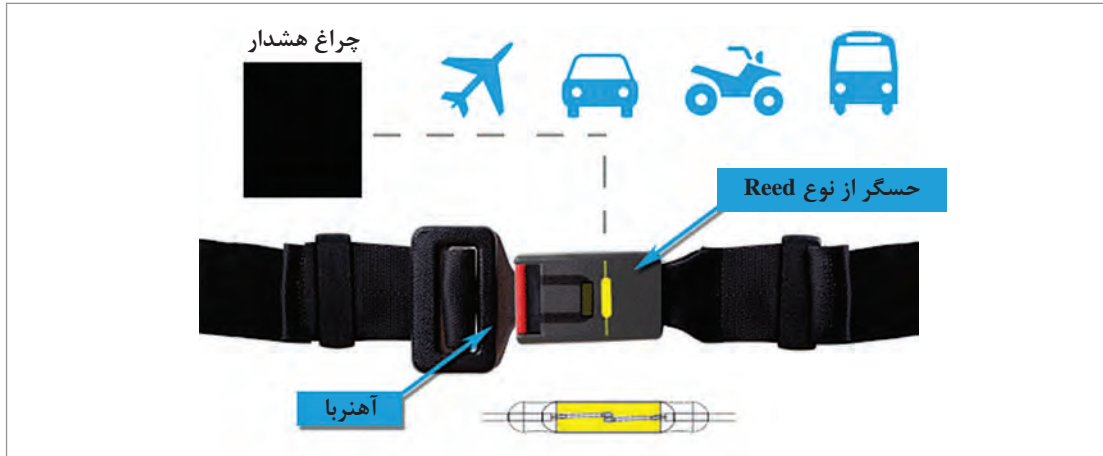
شکل ۲۳- عملکرد reed switch در کمر بند ایمنی
