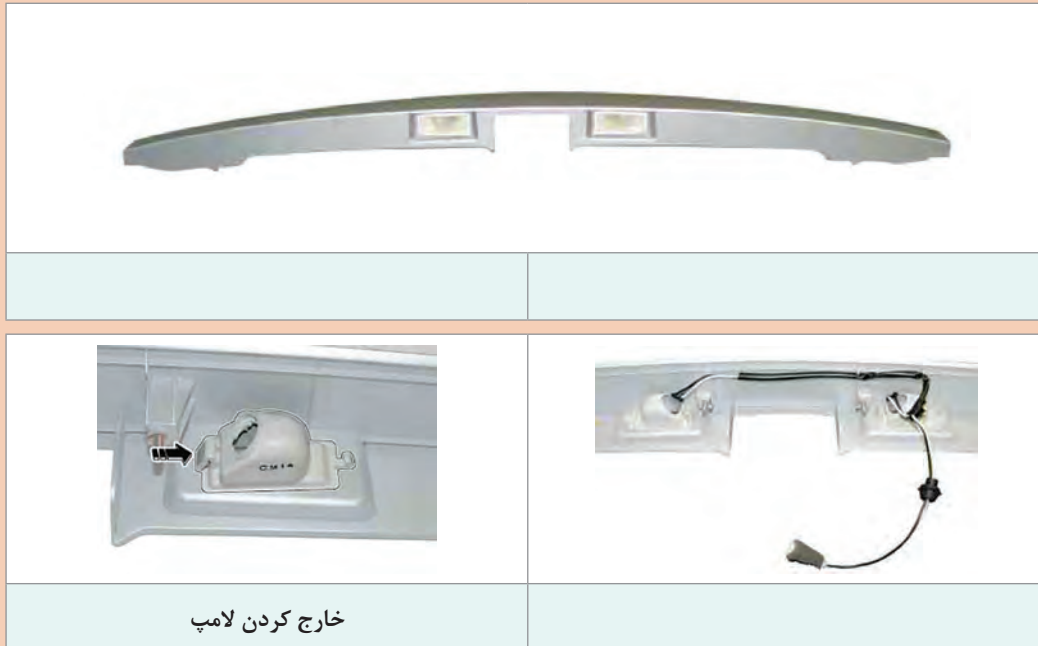
شکل ۳۵- روش باز کردن و بستن چراغ پلاک
