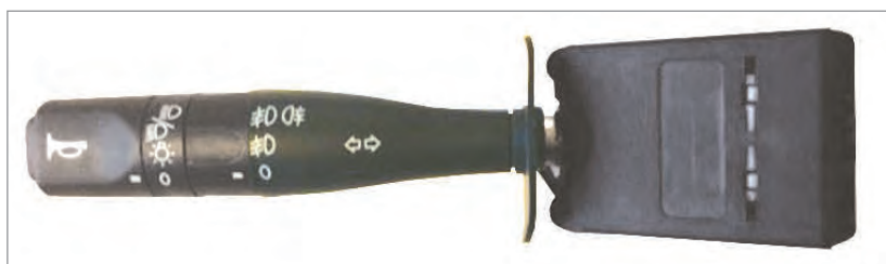
شکل ۱۳- نوعی کلید ترکیبی روشنایی
