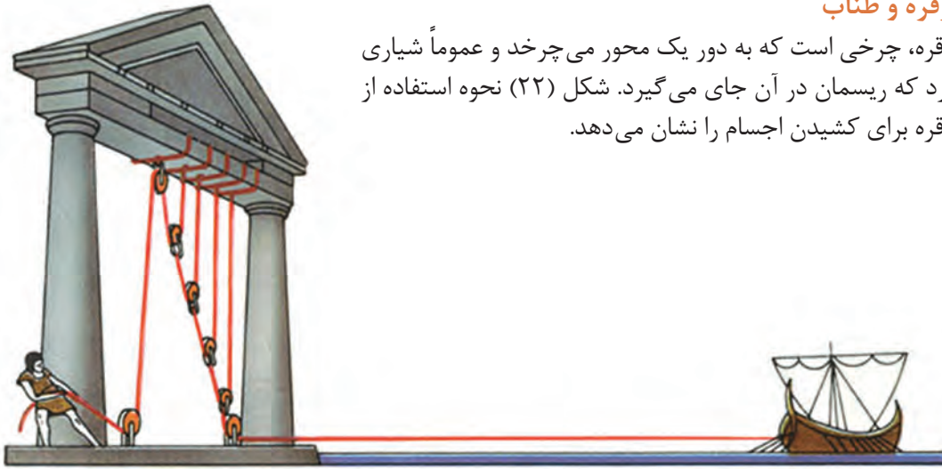
شکل ۲۲- استفاده از ترکیب چندین قرقره برای کشیدن اجسام
