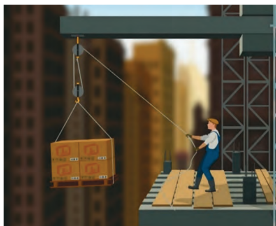
شکل ۲۶- ترکیب دو قرقه برای افزایش بهره مکانیکی
