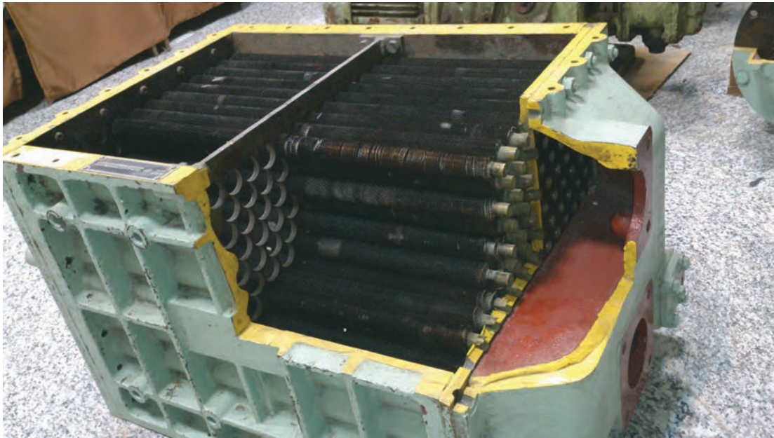
شکل ۲- کولر هوای یک موتور دیزل
