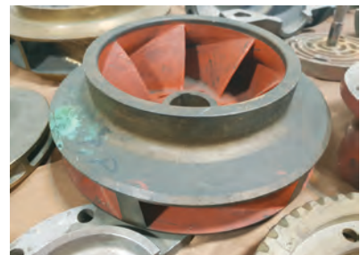
شکل ۳۶ ب) - پروانه بسته
