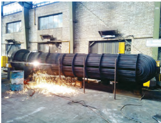
شکل ۱ - مبدل حرارتی ساخته‌شده برای نصب در پالایشگاه کرمانشاه را نشان می‌دهد.
