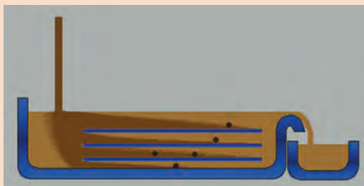
شکل ۲۰- نحوه قرار دادن صفحات موازی درون فیلتر
