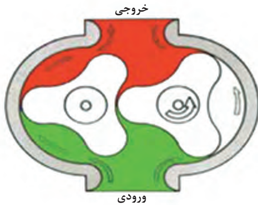
شکل ۸- ساختمان و نمای داخلی پمپ گوشواره‌ای
