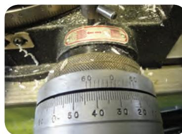
حلقه مدرج دستگیره میزگردان برای جابجایی دقیق تر
