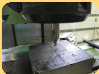
برای حرکت مته مرغک به سمت قطعه کار دستگاه را روشن کرده و از اهرم دستی و یا حرکت میز استفاده کنید. موقعیت اثر مته مرغک را به وسیله اندازه گیر مناسب کنترل کنید. معایب احتمالی را بر طرف کنید.
