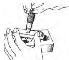
کنترل عمق سوراخ با استفاده از میکرومتر
