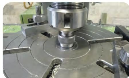
هم محور کردن گلوبی دستگاه با مرکز میزگردان به کمک یک میله تنظیم برای این کار کافی است میله مزبور داخل سوراخ میز قرار گیرد. در حالیکه میله تنظیم کاملاً در سوراخ میزگردان قرار دارد ورنیه میز عرضی و طولی را روی صفر تنظیم کرده و هر دو کشوی عرضی و طولی را قفل می کنیم. با بسته های ثابت کننده میزگردان را محکم ببندیم. میله تنظیم را از میزگردان خارج می کنیم.
