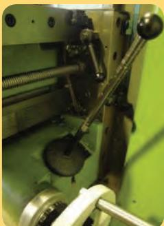
به وسیله پیچ‌های مخصوص، حرکت عرضی و عمودی میز ماشین را متوقف (ترمز) نمائید
