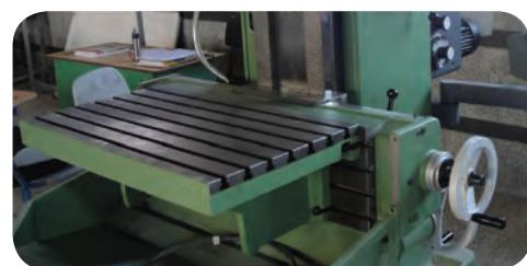
میز ماشین فرز و سیستم حرکتی آن
