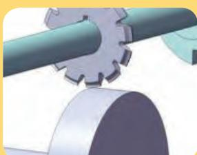
هنگام گردش تیغه فرز با حرکت طولی و عمودی میز ماشین تیغه فرز را روی چرخ مماس کنید
