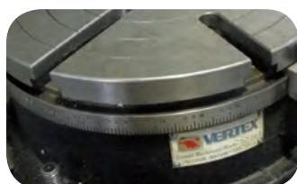
استفاده از شیارهای T میزگردان برای بستن گیره یا روبند
