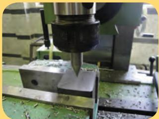
از روی نقشه اندازه های لازم را یادداشت کنید. با احتساب شعاع میله آن را در مرکز سوراخ کاری قطعه قرار دهید.
