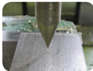
مشخص کردن محل دقیق سوراخ کاری به کمک یک میله راهنمای
