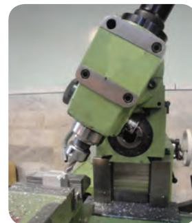
انحراف کله‌گی در صورتیکه از ماشین فرز عمودی برای چرخ دندنه مارپیچ استفاده شود
