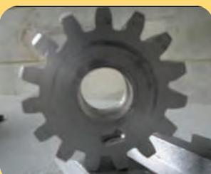
با تکرار مرحله ۱۰ تراش بقیه دندانه‌های چرخدنده را ادامه دهید. هنگام تراش چرخدنده از مواد خنک کننده مانند آب صابون و گازوئیل و یا کمپرس باد استفاده نمایید تا نوک تیغه فرز گرم نشده و از بین نرود.
