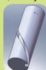
بر روی محور ماشین فرز عمودی نیز می‌توان تیغه فرز سوراخدار و میله فرز یک طرفه بست و با انحراف کله‌گی مقدار زاویه انحراف را ایجاد کرد و شیار مارپیچ را تولید کرد.
