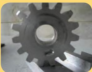
با حرکت طولی میز (موافق جهت دور تیغه فرز) تیغه فرز را از کار خارج نموده و میز را به حالت اول برگردانید. دسته حلوون دستگاه تقسیم را به اندازه حساب شده برای هر دندانه که قبلاً محاسبه و آماده شده بچرخانید. سپس شروع به تراشیدن شیار دوم چرخدنده نمائید.
