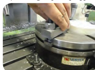
بستن قطعه با استفاده از روبند و زیر سری مناسب
