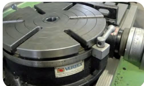
استفاده از میزگردان در قوس تراشی با ماشین فرز
