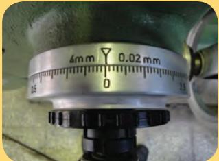
ضمن مماس کردن میله تنظیم با دو طرف قطعه کار ورنیه ها را در جهت طولی و عرضی روی صفر قرار دهید.
