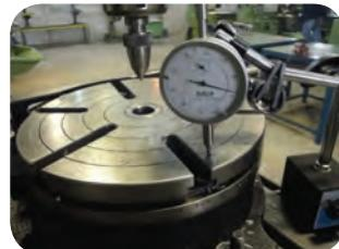
کنترل افقی بودن سطح میزگردان با ساعت اندازه‌گیری
