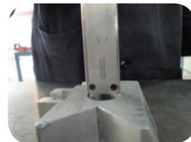
کنترل عمق سوراخ با استفاده از کولیس
