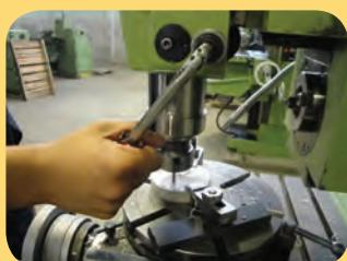
به یاد داشته باشید که در طول مدت براده برداری از آب صابون استفاده کنید و به وسیله اهرم دستی بار بدھید تا مته مرغک قطعه کار را کمی سوراخ نماید.
