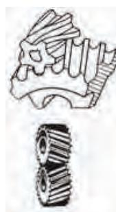
در گیری دو چرخ دنده مارپیچی
