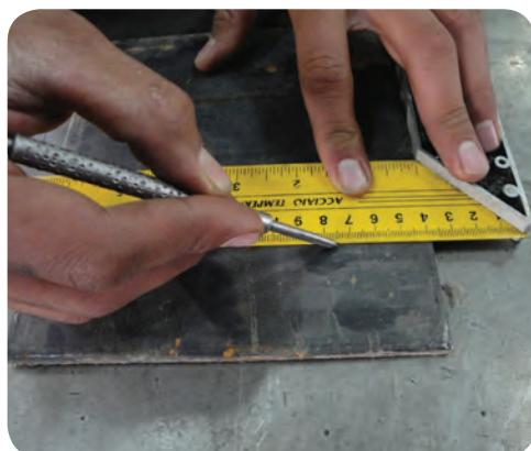
روش ترسیم خط به کمک گونیای ساده و سوزن خطکش
