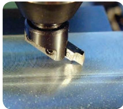
استفاده از مته لنگ برای فرم تراشی لبه های قطعات و کره تراشی بر روی دستگاه فرز
