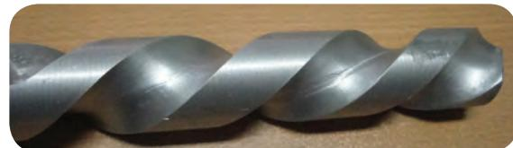
ایجاد شیار مارپیچ در یک میله گرد
