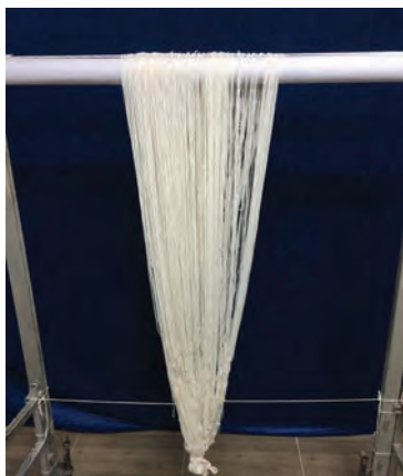
شکل ۳-۵- انتقال سردار بر روی دار بدون فندک
