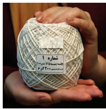
شکل ۱۷-۲- توپک ۲۰۰ گرمی، چله پنبه ای ۱۵ لا نمرة ۱۰
