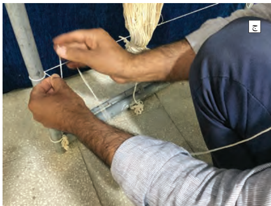
شکل ۷-۳- بازکردن نخ‌های کمکی
