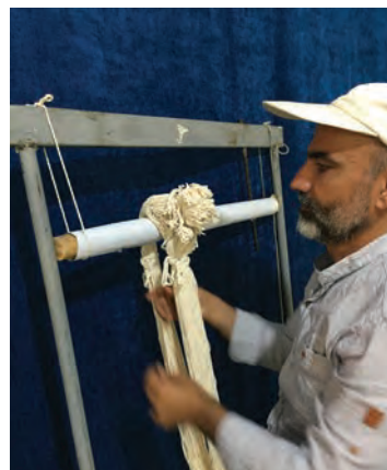
شکل ۳-۴- انتقال سردار بر روی دار فندک دار
