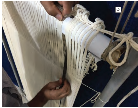
شکل ۱۳-۳- گره زدن دسته‌های چله بر روی سردار و تنظیم آنها
