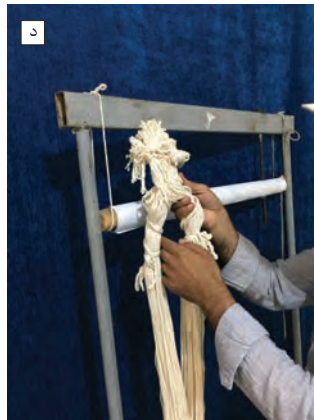
شکل ۳-۳- انتقال چله بردار
