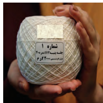
شکل ۱۶-۲- توپک ۲۰۰ گرمی، چله پنبه ای ۱۲ لا نمرة ۲۰
