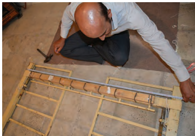
شکل ۱۶-۵ - نصب چوب پایین کشی پشت زيردار
