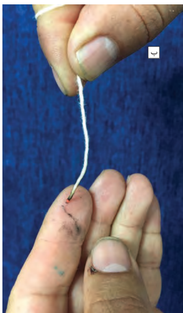
شکل ۱۱-۲- نخ چله پنبه‌ای در حالت سوزاندن
