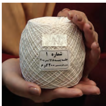
شکل ۱۸-۲- توپک ۲۰۰ گرمی، چله پنبه ای ۱۸ لا نمرة ۲۰
