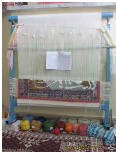
شکل ۱۰-۱- زیر دار ثابت و سردار متحرک (مدل ۲)
