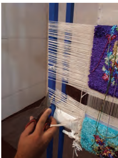
شکل ۳۴-۵ - بریدن انتهای پودها قبل از پایین کشی
