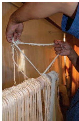
شکل ۱۱-۵ - باز کردن گره‌های سر دار
