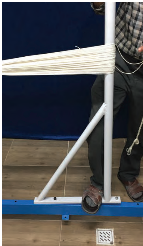
شکل ۳۸-۲- بستن انتهای چله به میله
