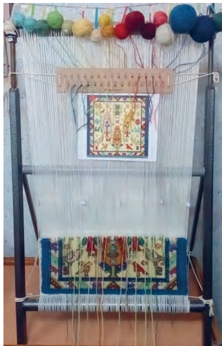
شکل ۹-۱- زیر دار ثابت و سردار متحرک (مدل ۱)
