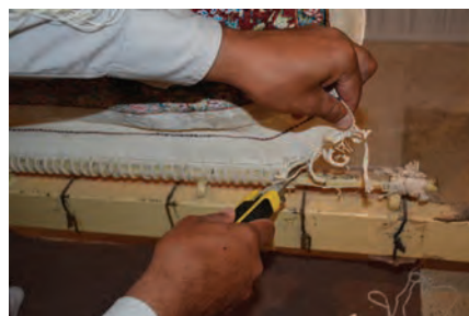
شکل ۱۳-۵ - بریدن دوخت ابتدای چله
