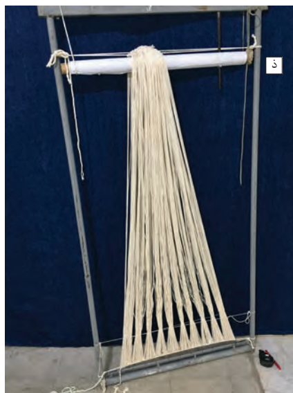
شکل ۸-۳- مه‌ار ابتدای چله به زیردار
