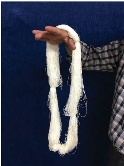
شکل ۲۲-۲- برداشتن کلاف و باز کردن تاب کلی
