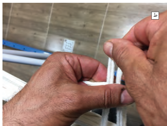
شکل ۳۵-۲- مراحل زدن نزله بین میله دوم و تیرک کمکی
