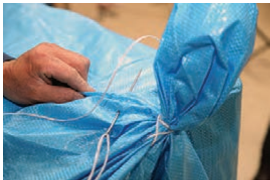
شکل ۸۰- جمع کردن گوشه‌های دهانه و دوختن آنها
