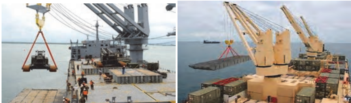
شکل ۱۲-۵- تخلیه و بارگیری کالا با استفاده از جرثقیل کشتی
