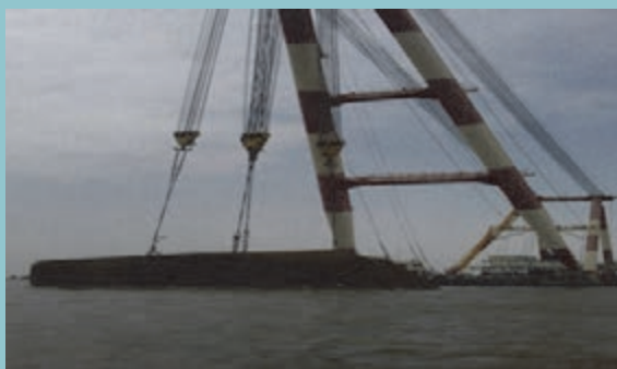
عملیات خارج‌سازی شناور "کارون بار" با استفاده از جرثقیل شناور از قعر آب‌های اروندرود
