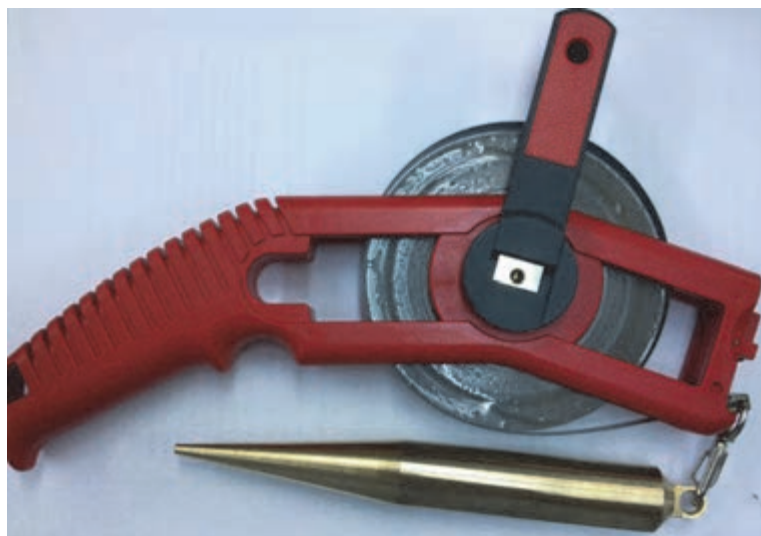
شکل ۶-۳- Sounding tape برای اندازه‌گیری سطح مخزن
